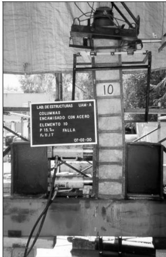
Figura 66. Ensayo de columna encamisada con perfiles angulares y placas transversales.
