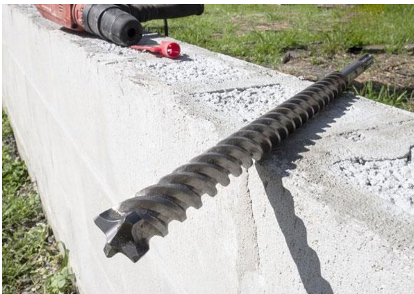
Figura 187. Broca para hormigón de 28 mm de diámetro.
