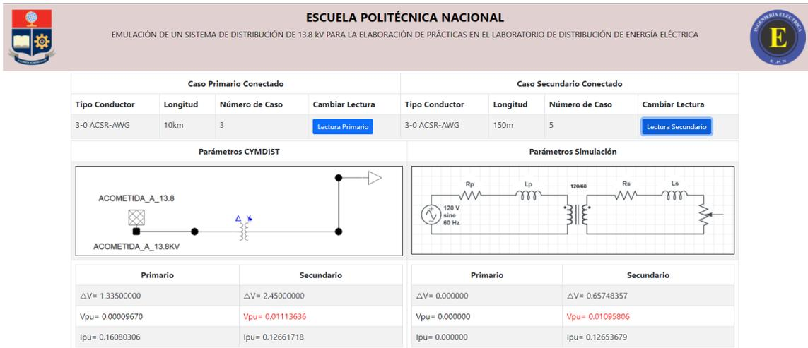
**Figura III.3.** Caída de voltaje alimentador primario #3/0 AWG ACSR 10 km y circuito secundario #3/0 AWG ACSR 150 m
