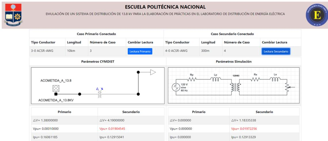
**Figura III.2.** Caída de voltaje alimentador primario #3/0 AWG ACSR 10 km y circuito secundario #4/0 AWG ACSR 300 m
