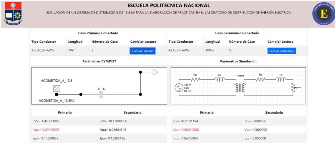
**Figura II.1.** Caída de voltaje alimentador primario #3/0 AWG ACSR 10 km y circuito secundario #2 AWG ACSR 300 m
