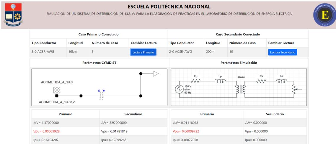
**Figura II.2.** Caída de voltaje alimentador primario #3/0 AWG ACSR 10 km y circuito secundario #2/0 AWG ACSR 200 m
