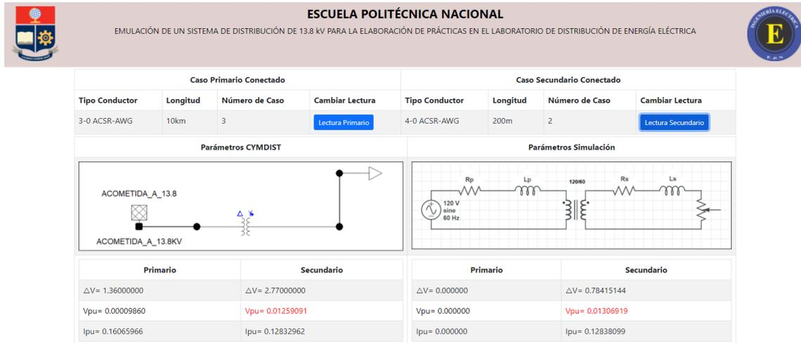
**Figura III.1.** Caída de voltaje alimentador primario #3/0 AWG ACSR 10 km y circuito secundario #4/0 AWG ACSR 200 m
