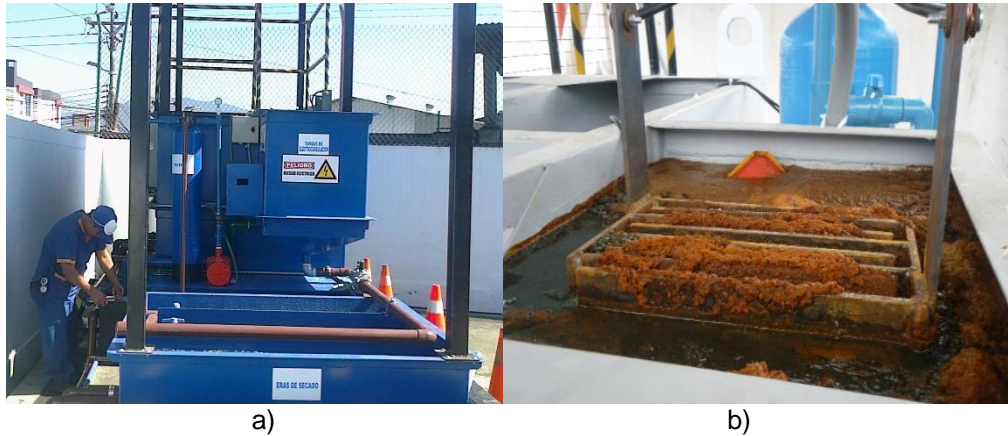
Figura 2.2. a) Planta de tratamiento por electrocoagulación. b) Reactor electrolítico en operación.
