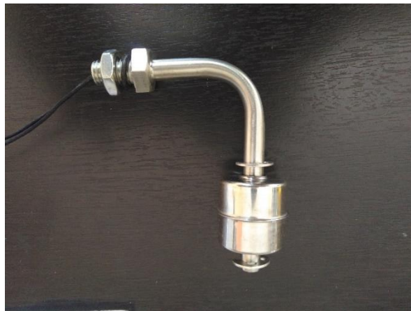
Figura 2.17. Interruptor de nivel de líquido con flotador magnético.
