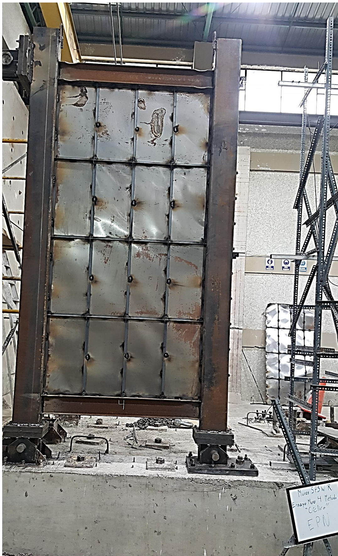
Figura 92. Muro SPSW rigidizado número 4: ensayo de cargas cíclicas por el método "C". Fuente: Elaborado por Carlos Gallegos.
