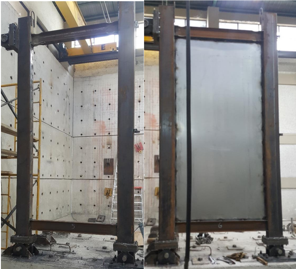
Fotografía 15: Pórtico luego de llegar al límite de desplazamientos
