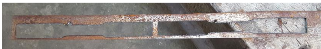
Figura 80. Tira sobrante de la plancha de acero de 1,4mm luego de la extracción de las probetas. Fuente: Elaborado por Carlos Gallegos.
