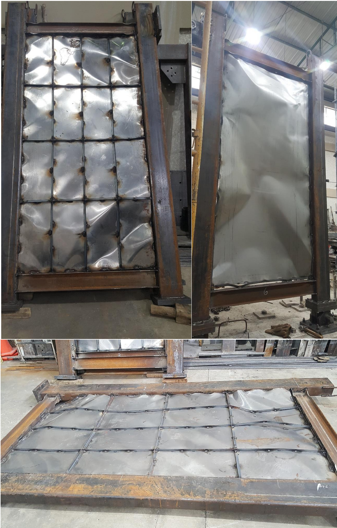
Fotografía 16: Muros luego del ensayo.
