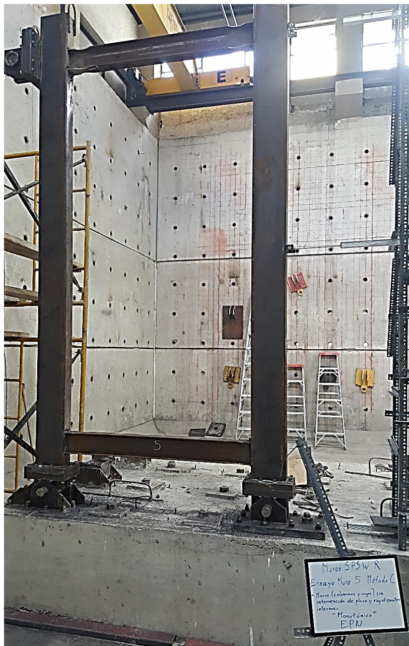
Figura 95. Muestra número 5 (pórtico): ensayo monotónico. Fuente: Elaborado por Carlos Gallegos.
