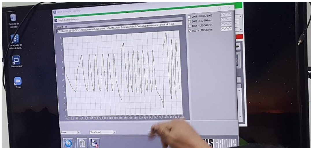
Figura 86. Gráfica desarrollada por el equipo de ensayo durante la aplicación de las cargas cíclicas.
