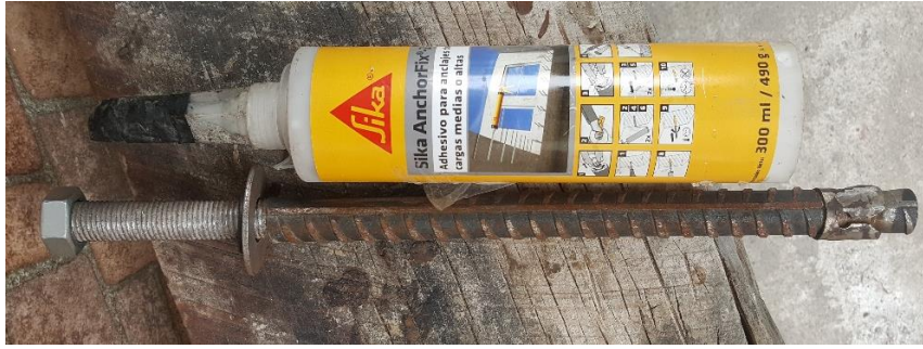
Figura 69. Perno de anclaje expansivo y epóxico utilizados en la cimentación. Fuente: Elaborado por Carlos Gallegos.
