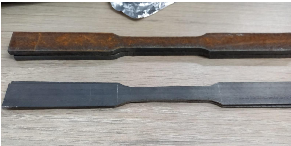
Figura 99. Probetas de acero entregadas al laboratorio de ensayo de materiales. Fuente: Elaborado por Carlos Gallegos.
