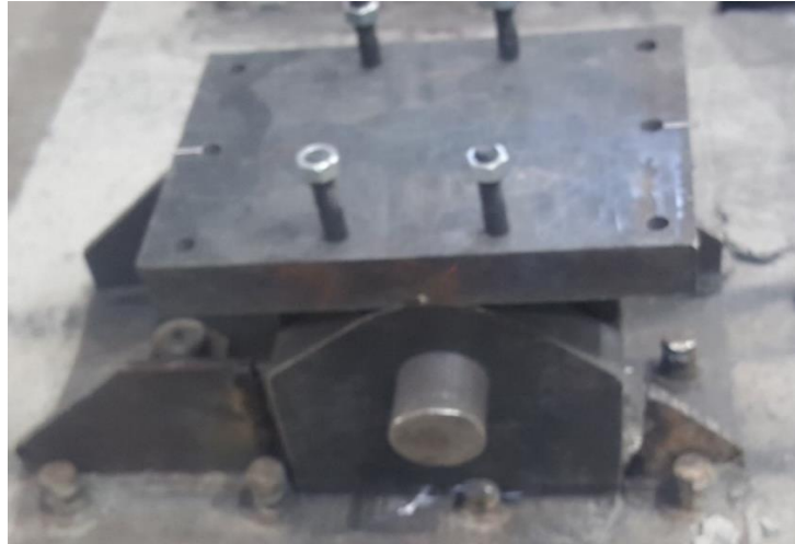
Figura 72. Colocado de la rótula en el empotramiento preparado. Fuente: Elaborado por Carlos Gallegos.
