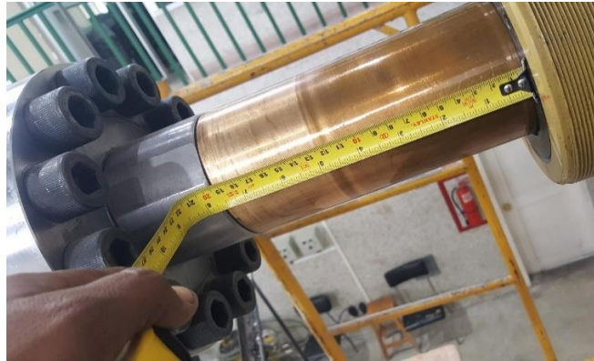
Figura 75. Comprobación del desplazamiento del émbolo en el gato hidráulico. Fuente: Elaborado por Carlos Gallegos.
