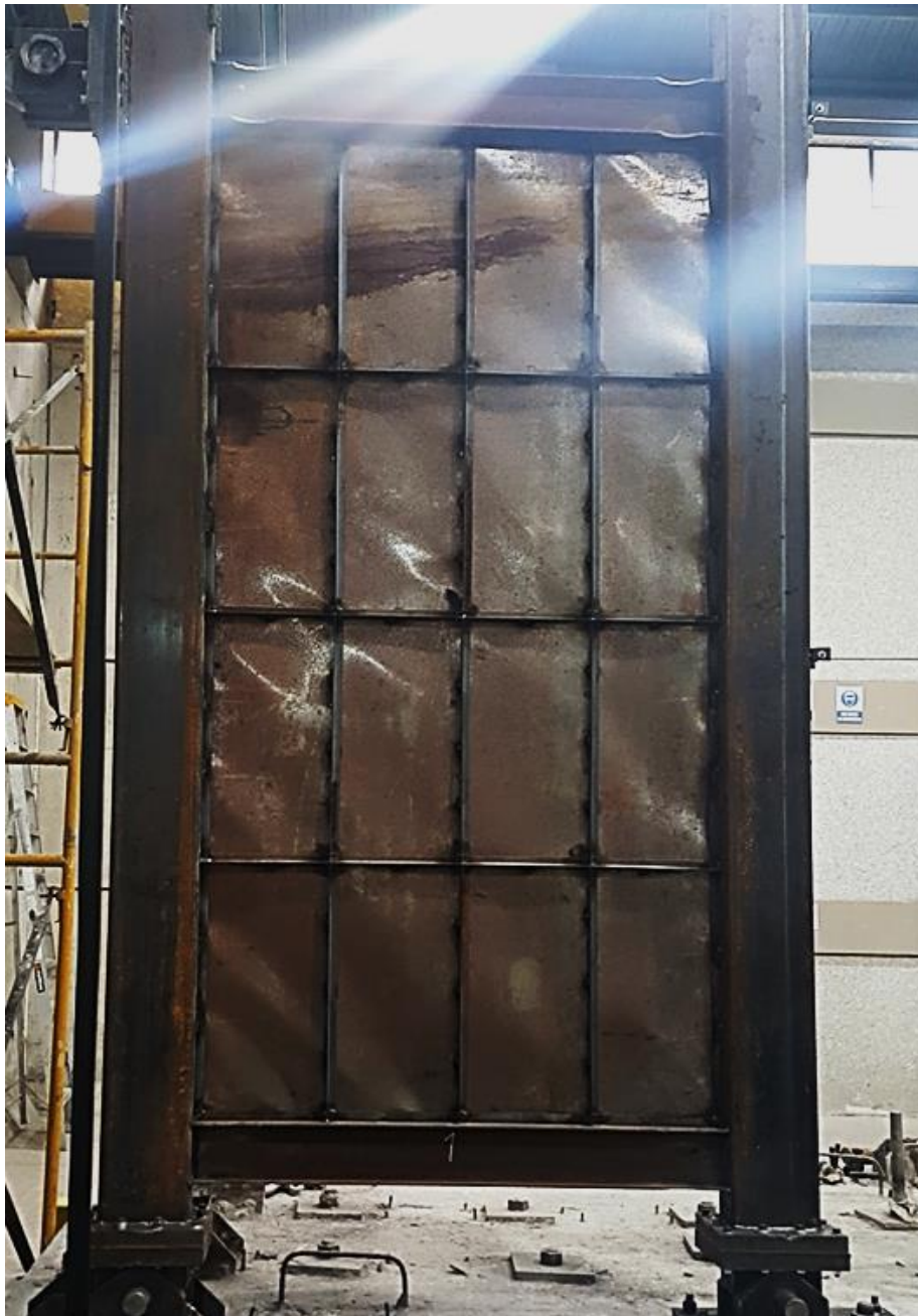
Figura 85. Muro SPSW rigidizado número 1 durante el ensayo de cargas cíclicas. Fuente: Elaborado por Carlos Gallegos.
