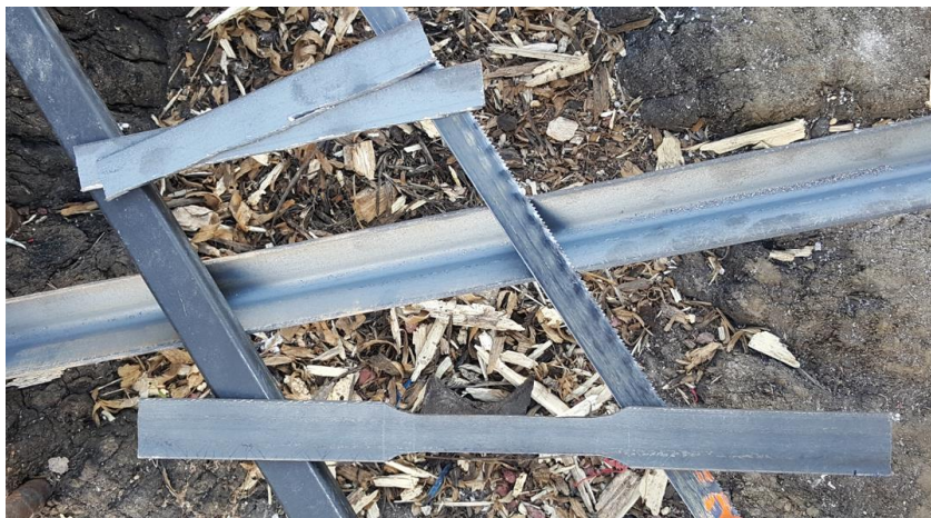
Figura 82. Probeta de acero extraída de la separación de una de las alas del ángulo utilizado como rigidizador.
