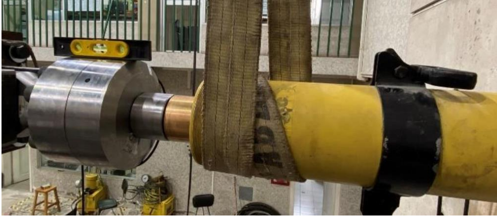
Figura 77. Nivelación del gato hidráulico. Fuente: (Benítez Guachalá & Vitar Semanate, 2022).
