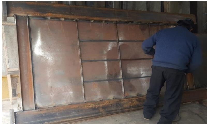
Figura 61. Distribución de rigidizadores verticales de 60cm cada pieza. Fuente: Elaborado por Carlos Gallegos.
