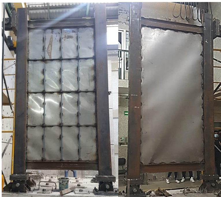
Fotografía 18: Muros rigidizado y sin rigidizar durante el ensayo de cargas cíclicas.
