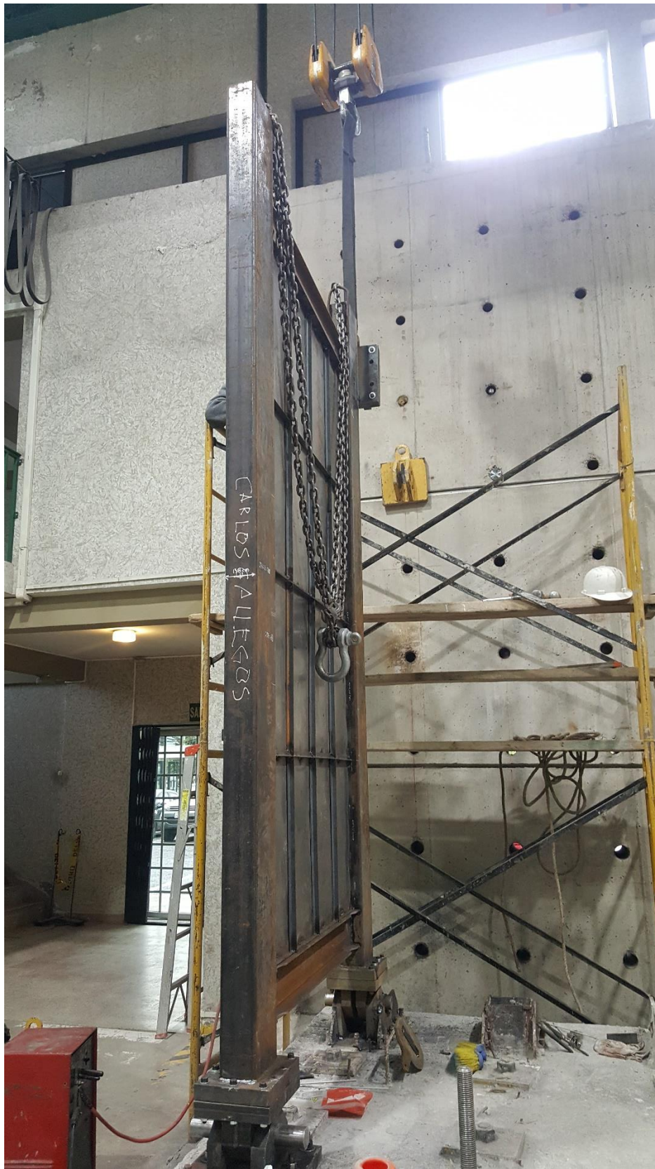
Fotografía 8: Muro con cadena para ser transportado por el puente grúa.
