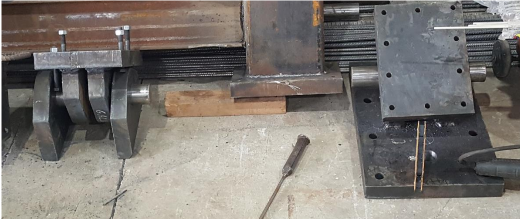
Fotografía 5: Moldeado de las secciones RBS.
