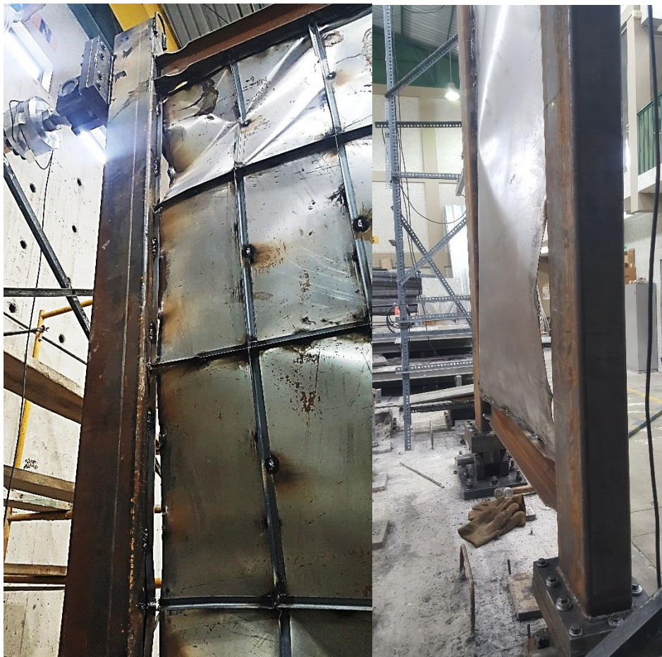
Fotografía 18: Muros rigidizado y sin rigidizar durante el ensayo de cargas cíclicas.
