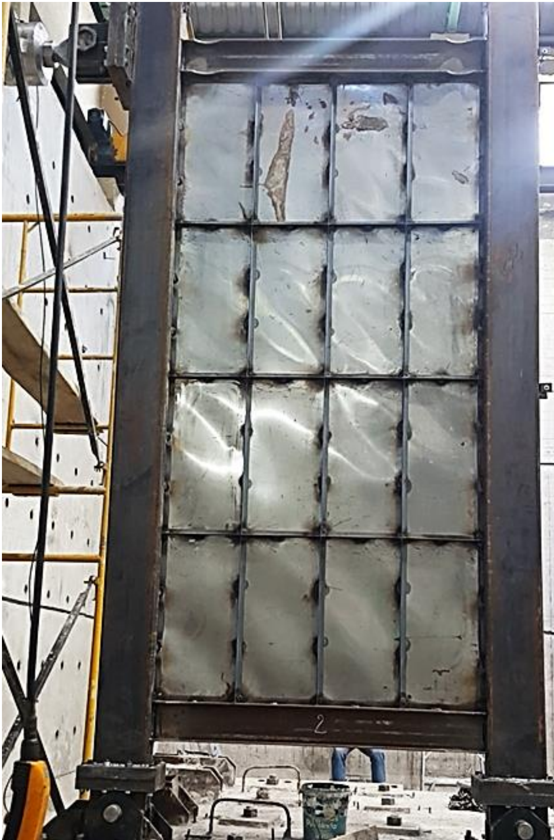
Figura 89. Muro SPSW rigidizado número 2 durante el ensayo de cargas cíclicas. Fuente: Elaborado por Carlos Gallegos.
