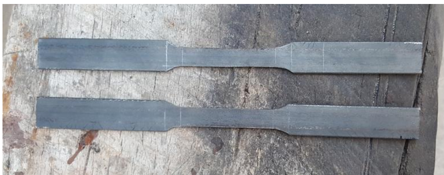
Figura 83. Muestras de acero extraídas del ángulo rigidizador.
