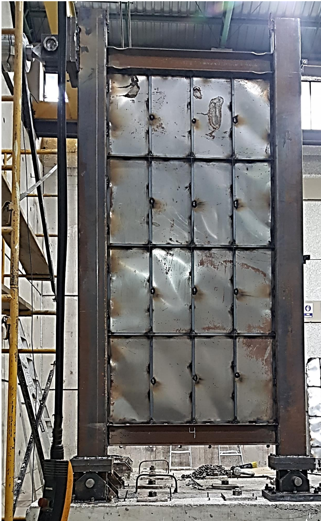
Figura 93. Muro SPSW rigidizado número 4 durante el ensayo de cargas cíclicas. Fuente: Elaborado por Carlos Gallegos.
