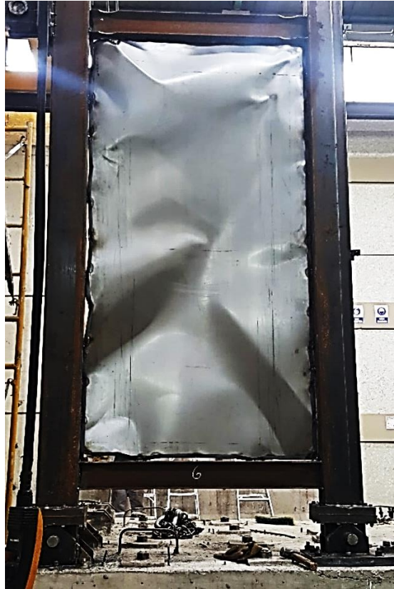
Figura 127. Muro SPSW luego del ensayo. Fuente: Elaborado por Carlos Gallegos.
