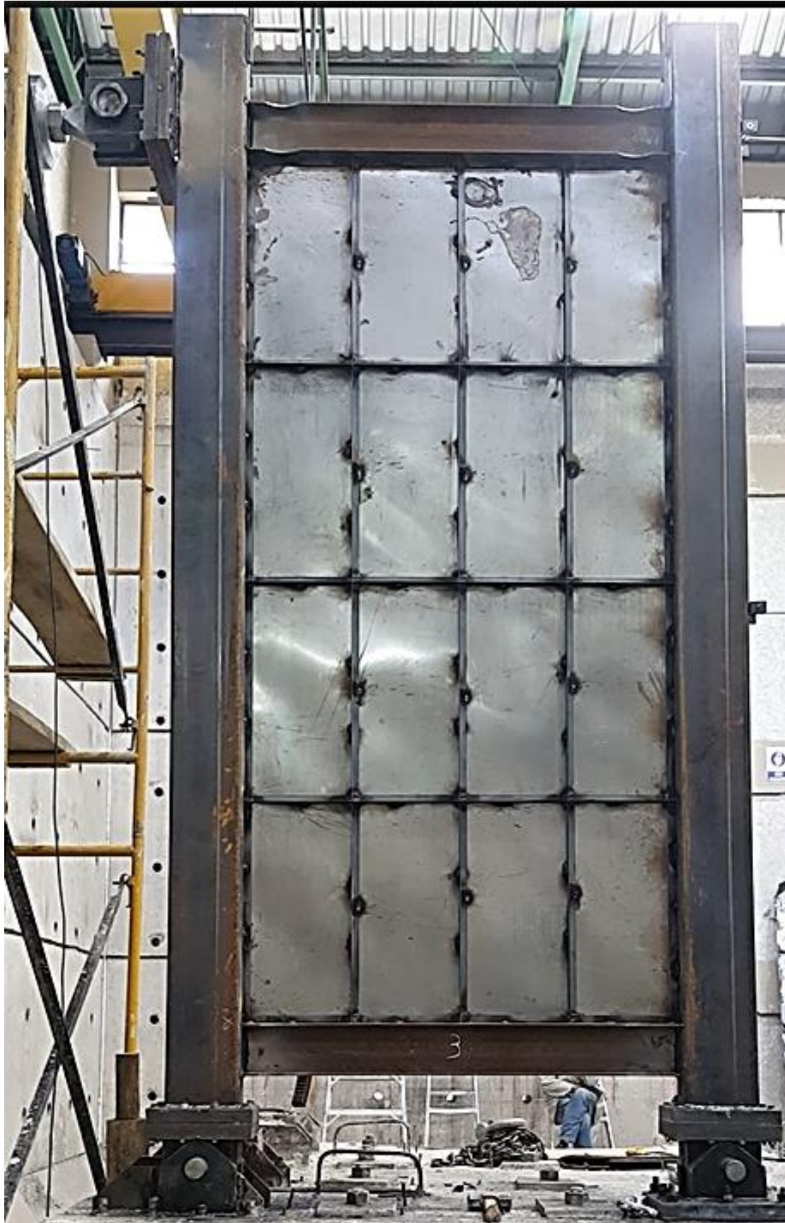
Figura 91. Muro SPSW rigidizado número 3 durante el ensayo de cargas cíclicas. Fuente: Elaborado por Carlos Gallegos.
