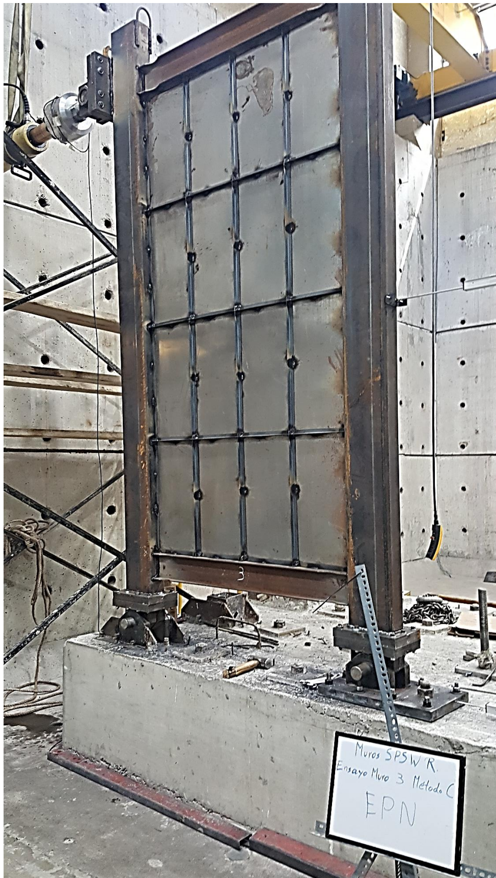
Figura 90. Muro SPSW rigidizado número 3: ensayo de cargas cíclicas por el método “C”. Fuente: Elaborado por Carlos Gallegos.
