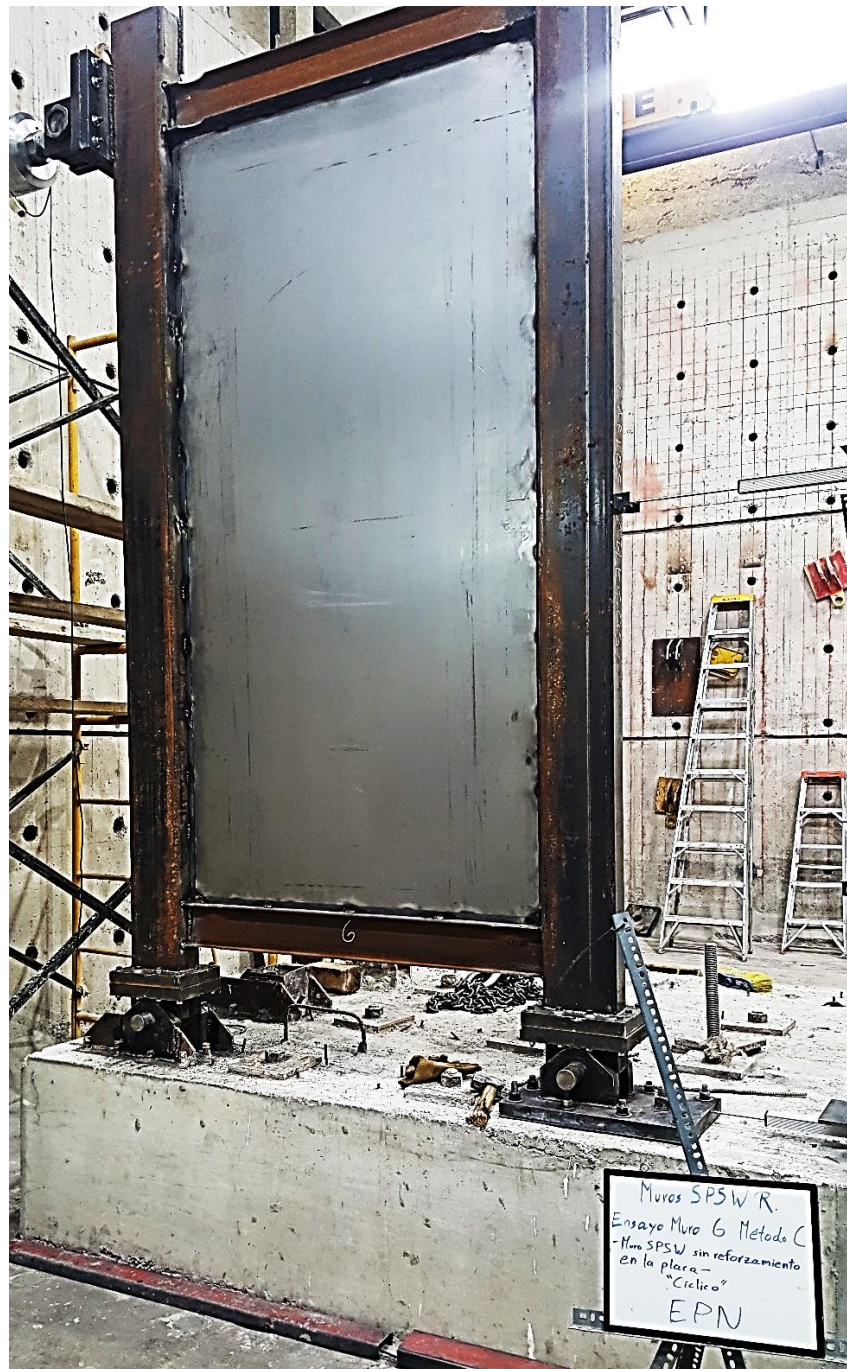
Figura 97. Muestra número 6 (muro SPSW): ensayo de cargas cíclicas por el método "C".
