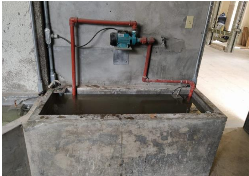
Figura 27. Tanque de inmersión para saturación de ladrillo
