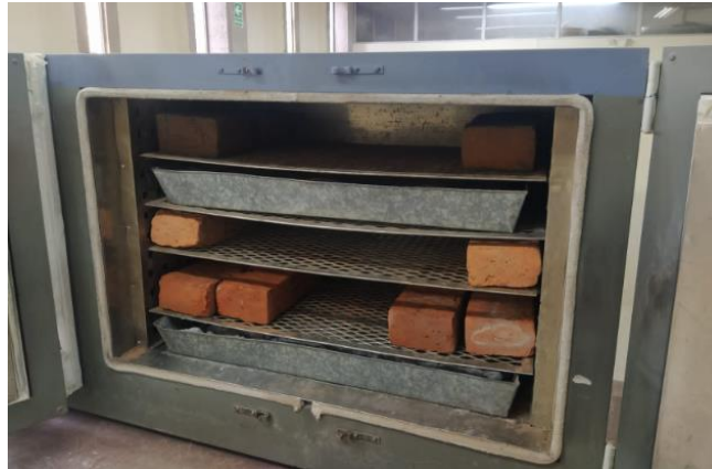
Figura 25. Secado de unidades de ladrillo
