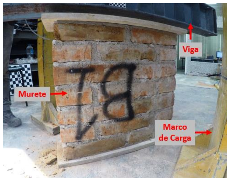
Figura 38. Murete de ladrillo para compresión ubicado bajo el marco de carga
