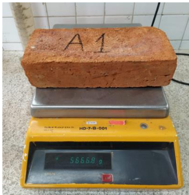
Figura 26. Pesaje de muestras secas de ladrillo.
