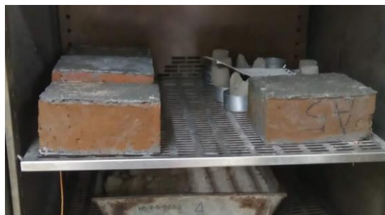
Figura 30. Secado de especímenes de ladrillo para compresión
