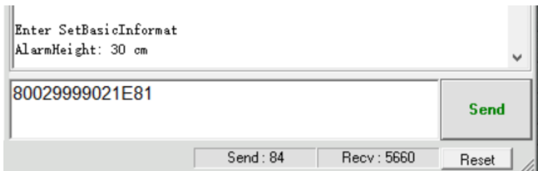
Figura 2.35 Establecimiento de alarma de altura a 30cm.
