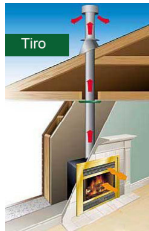
Figura 2.5. Tiro natural de gases de combustión (Fuente: Climatización Alcazar, 2018)
