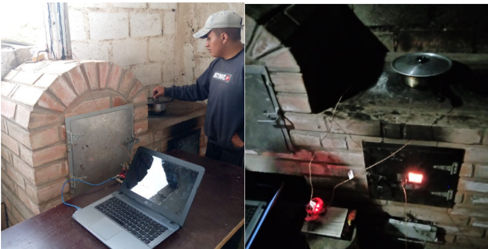
Medición de temperatura en la puerta de la cámara de combustión y horno.
