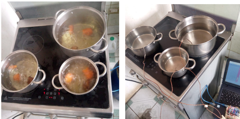
Puebas de ebullición y cocción en cocina de inducción
