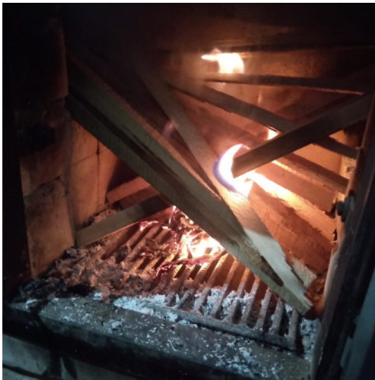
Verificación de encendido en la cámara de combustión
