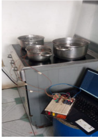
Prueba control de temperatura cocina de inducción
