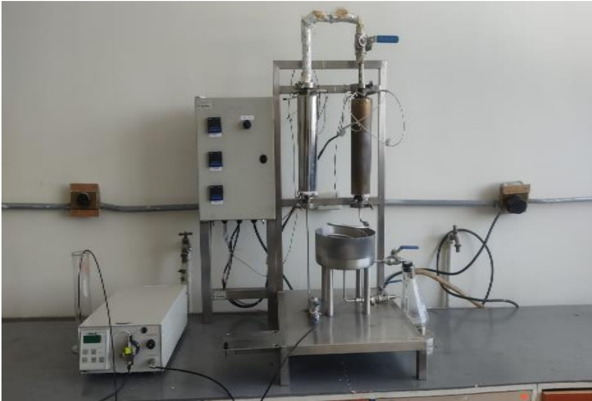
Figura 1. Reactor de lecho empacado ubicado en el Laboratorio de termodinámica de la Escuela Politécnica Nacional.
