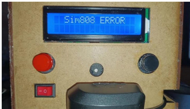
Figura 3.29 Fallo de conexión a la red GSM
