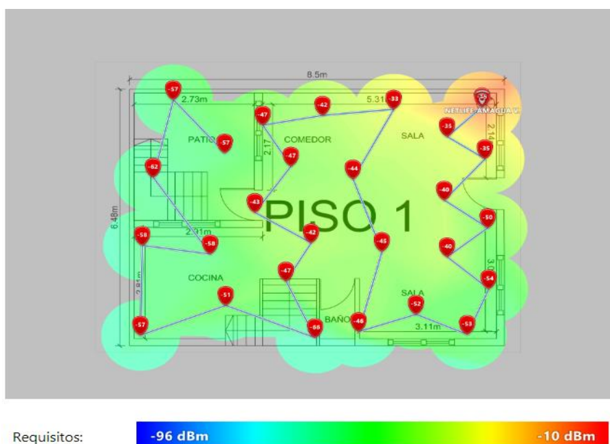
Figura 3.80 Nivel de señal Wi-fi de 5 (GHz) con el PLC en el primer piso
