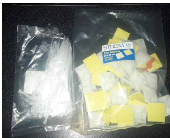
Figura 3.43 Bases adhesivas cuadradas y amarras plásticas
