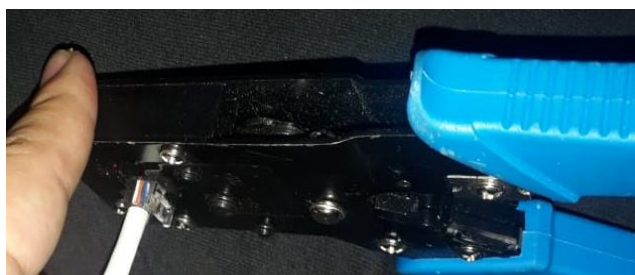
Figura 3.35 Uso de la pochadora para fijar el conector RJ45
