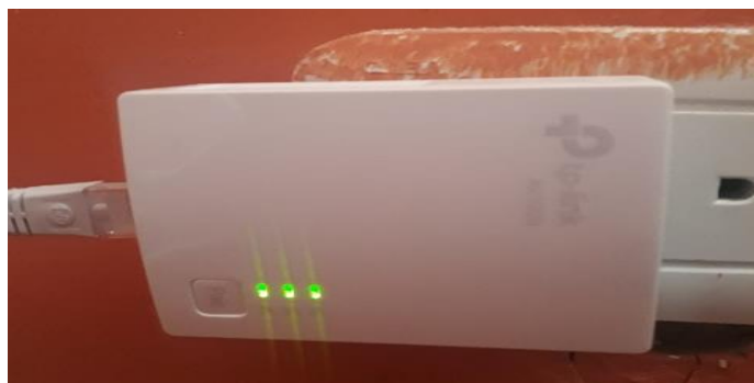
Figura 3.32 Dispositivo PLC conectado al tomacorriente del primer piso
