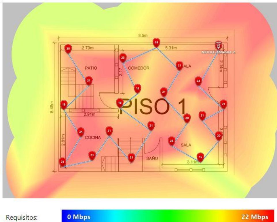
Figura 3.69 Velocidad de subida de la banda de 2.4 (GHz) con el PLC en el primer piso
