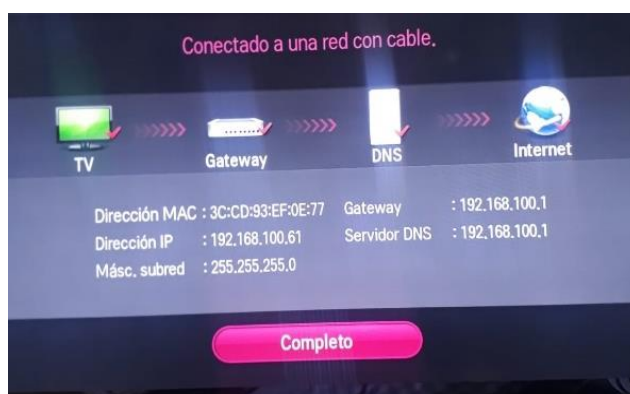
Figura 3.42 Verificación de la conexión cableada de la televisión del segundo piso
