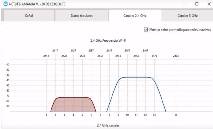
Figura 3.48 Canales de operación de las redes Wi-fi de 2.4 (GHz) de la vivienda
