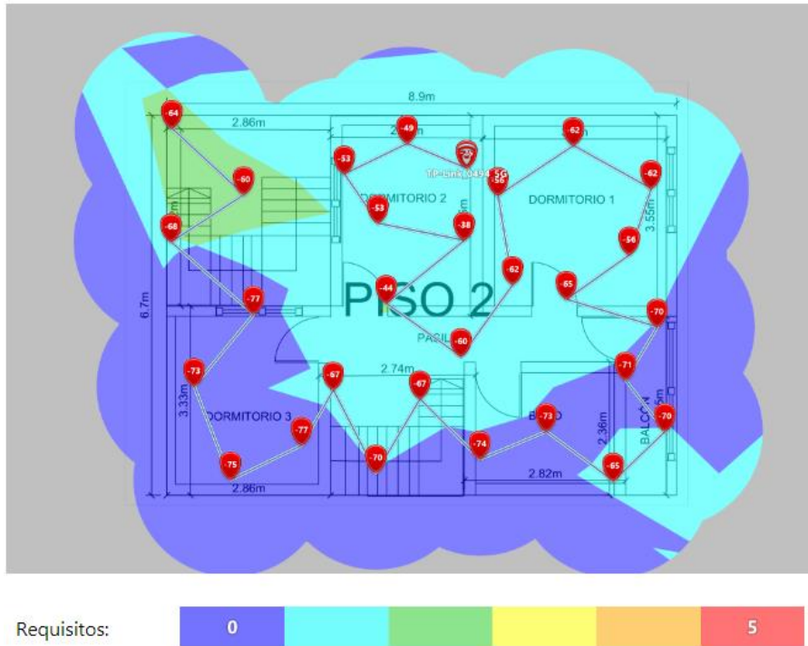
Figura 3.92 Número de APs de la red Wi-fi de 5 (GHz) con el PLC del segundo piso
