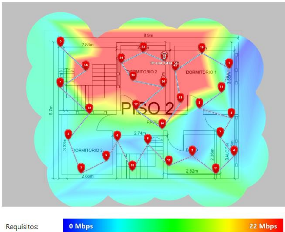
Figura 3.89 Velocidad de descarga Wi-fi de 5 (GHz) con el PLC en el segundo piso
