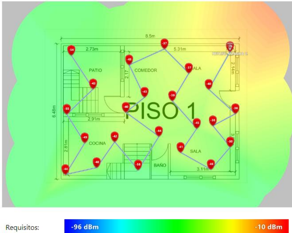
Figura 3.66 Nivel de señal Wi-fi de la banda de 2.4 (GHz) con el PLC en el primer piso
