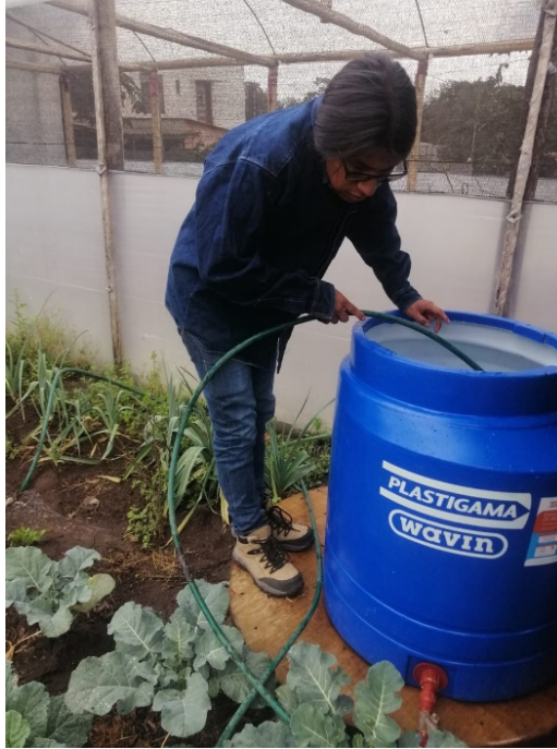
Figura 3.3 Pruebas de fuga en el reservorio de agua
