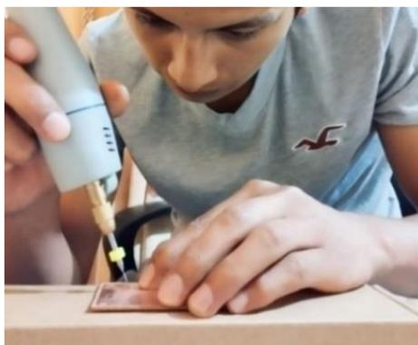
**Figura 3.12** Proceso de perforación
