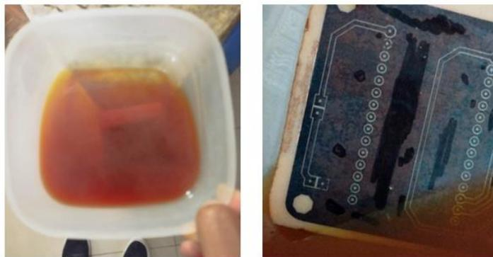
**Figura 3.11** Disolución de cloruro férrico en agua caliente
