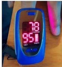
**Figura 3.32** Medición del ritmo cardíaco mediante un pulsioxímetro comercial
