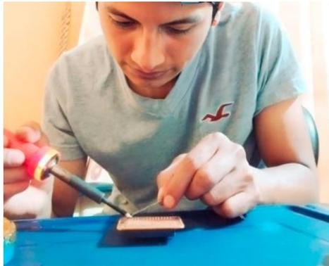
**Figura 3.13** Proceso de soldado de los componentes
