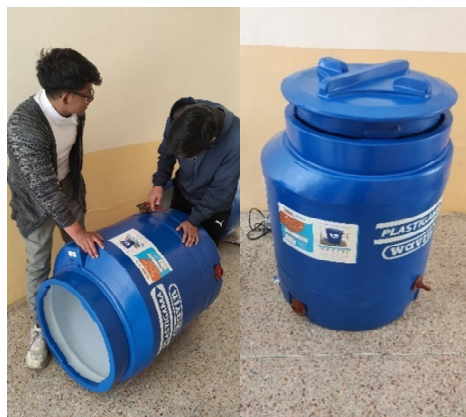
Figura 2.20. Instalación de acoples de conexión con la bomba
