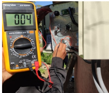
Figura 3.1. Prueba de continuidad de conductores eléctricos
