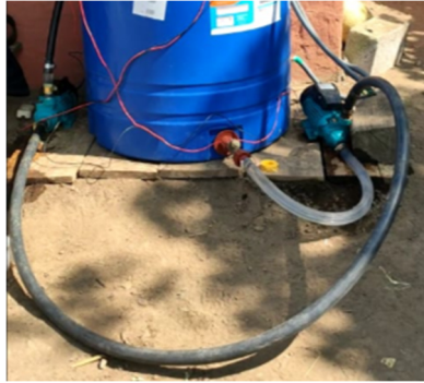
Figura 3.5. Succión y descarga de la bomba
