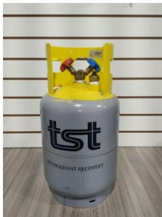
Figura 2.17 Tanque para recuperar R134A
