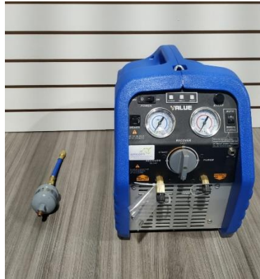
Figura 2.16 Recuperador de refrigerante junto con su filtro.
