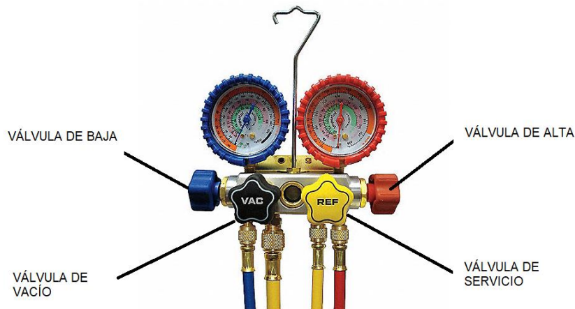
Figura A. 1 Partes del juego de manómetros de 4 válvulas.
