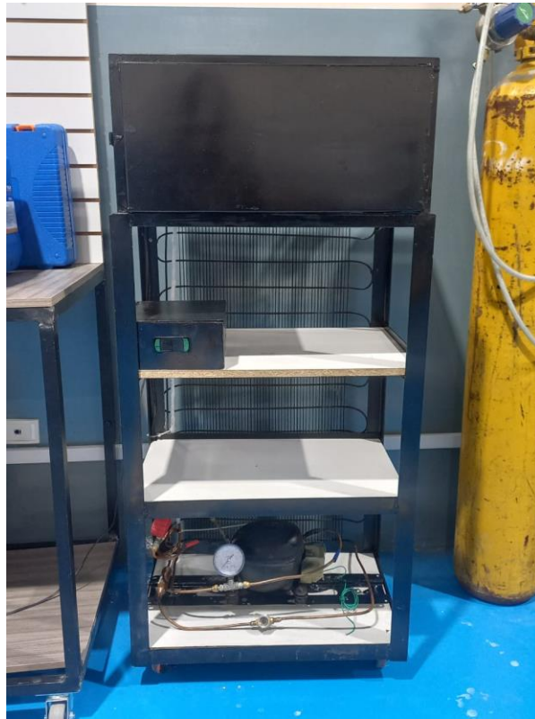
Figura 2.10 Modulo de refrigeración
