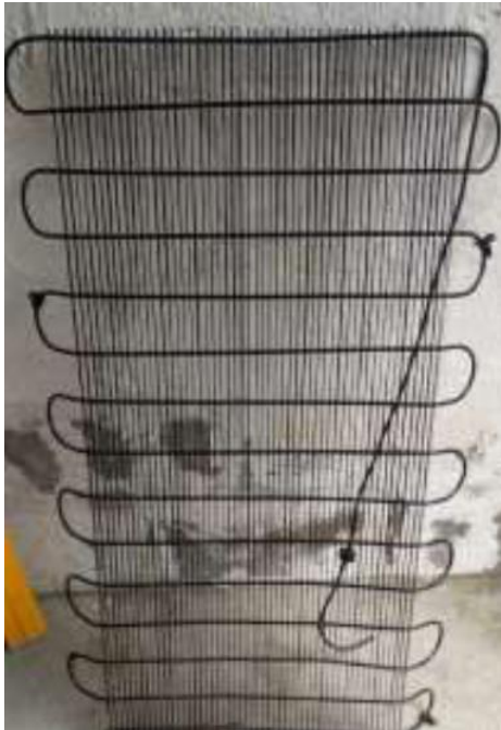
Figura 2.3 Condensador del sistema de refrigeración, [8].
