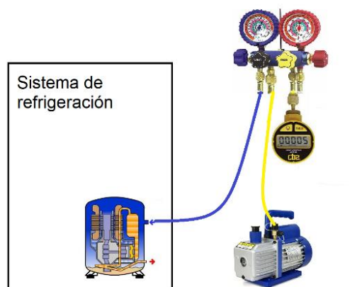
Figura 2.23 Esquema de conexión para realizar el vacío al sistema
