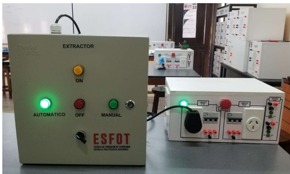
Figura 3.3 Comprobación de estado de Modo Automático.
