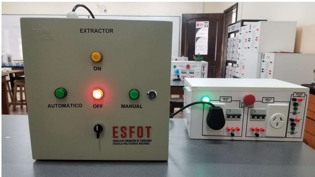
Figura 3.1 Comprobación de estado de apagado del extractor.
