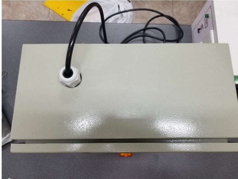
Figura 2.11 Perforación parte superior para alimentación.
