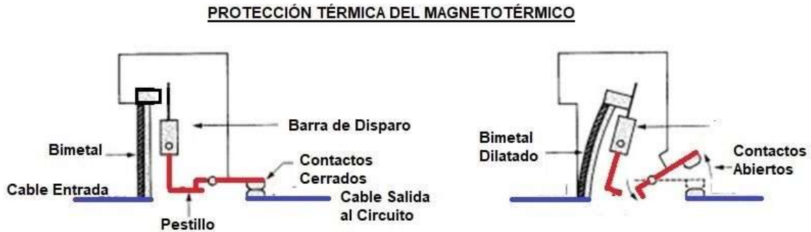
Figura 1.8 Accionamiento térmico de interruptor termomagnético, [11].
