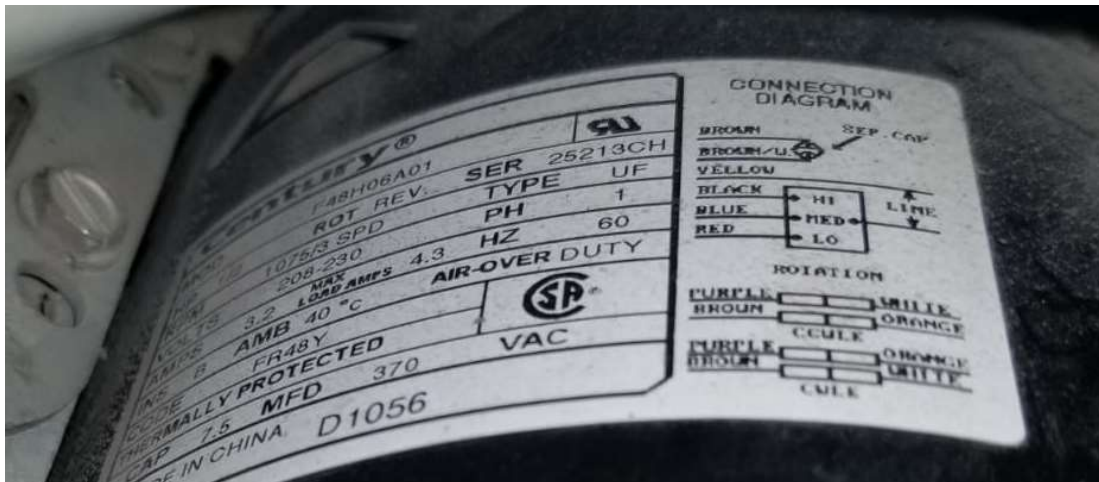
Figura 1.12 Placa de datos de motor Century D1056.
