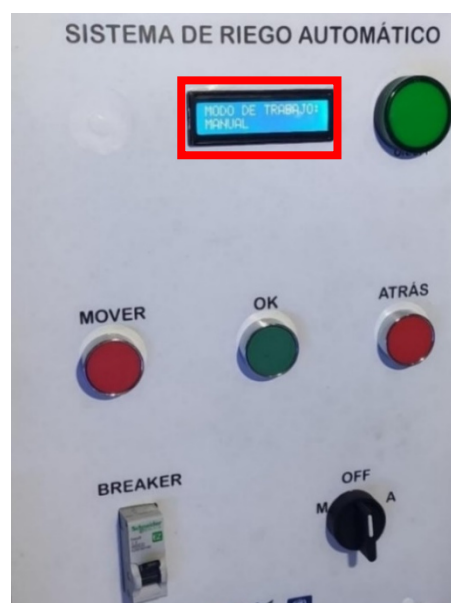
Figura 3.2. Funcionamiento modo Manual.
