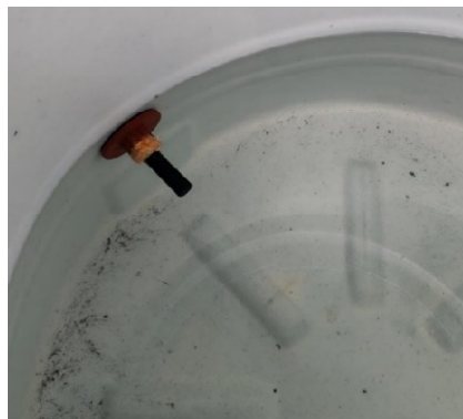
Figura 3.6. Funcionamiento del sensor de nivel.
