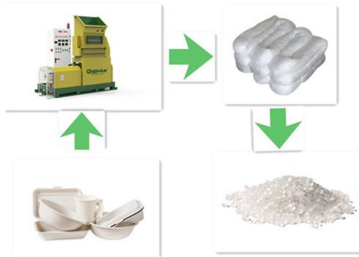
FIGURA 3. Proceso mecánico de reciclaje del EPS Fuente: (Greenmax, 2018)
