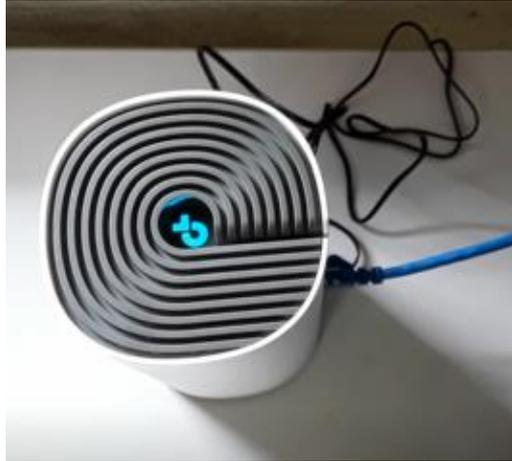
**Figura 3.82** LED en azul intermitente del Deco
