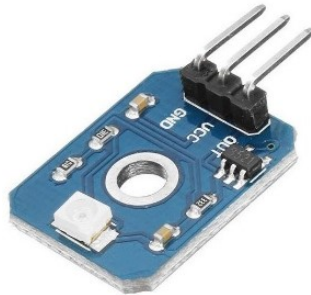
Figura 3.5 Módulo Sensor GUVA-S12SD [18]
