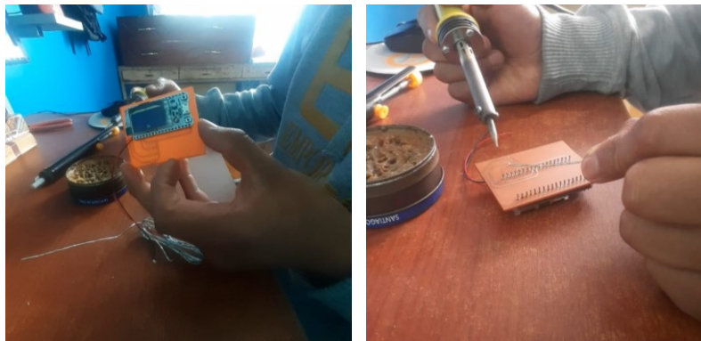
Figura 3.21 Soldadura de los elementos a la baquelita
