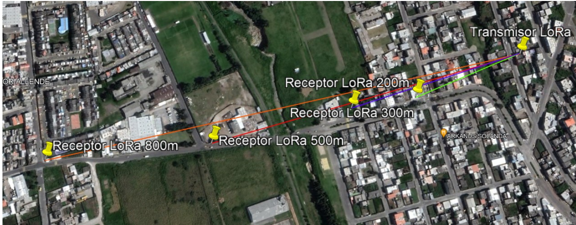
Figura 3.39 Ubicación del transmisor y receptor a una distancia de 800 (m)
