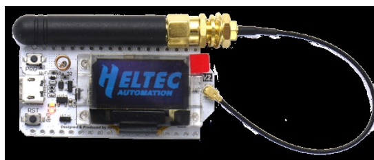
Figura 3.3 Módulo Heltec LoRa 32 con antena integrada [12]
