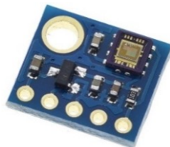
Figura 1.3 Módulo sensor de rayos UV ML8511 [11]
