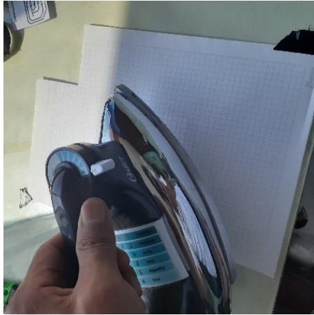
Figura 3.18 Transferencia del circuito PBC por medio de la técnica del planchado
