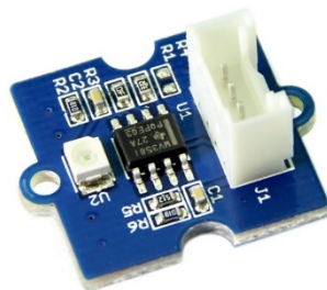
Figura 3.6 Módulo sensor UV GUVA-S12SD marca Seeed Studio [20]
