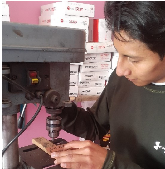
Figura 3.19 Perforación de la baquelita
