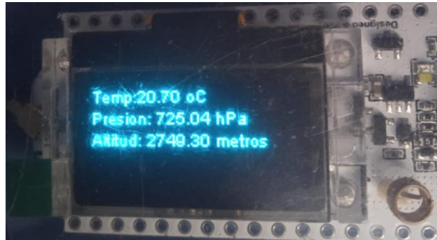
Figura 3.37 Módulo receptor con los valores de presión y altitud.
