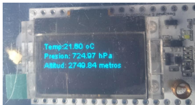
Figura 3.39 Módulo receptor con los valores de presión y altitud.
