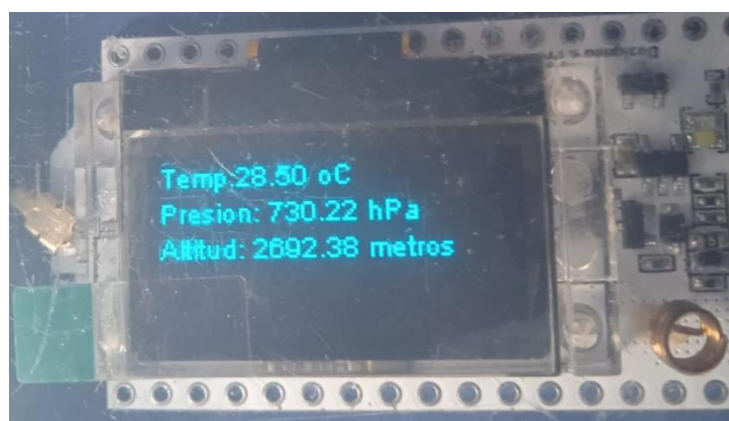
Figura 3.50 Módulo receptor con los valores de presión y altitud.
