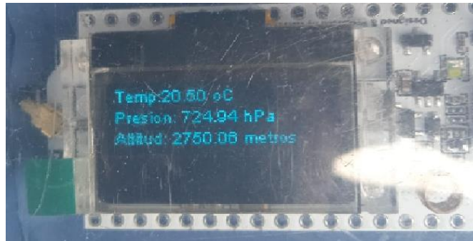
Figura 3.35 Módulo receptor con los valores de presión y altitud.
