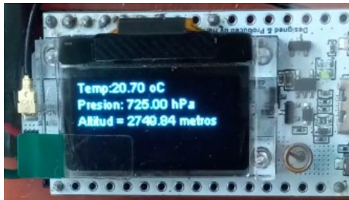
Figura 3.38 Módulo transmisor con los valores atmosféricos.
