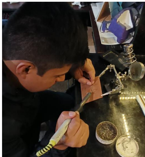
Figura 3.16 Proceso de soldadura.
