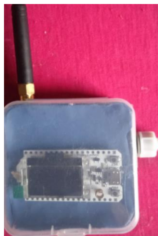
Figura 3.55 Módulo receptor en la caja portable.
