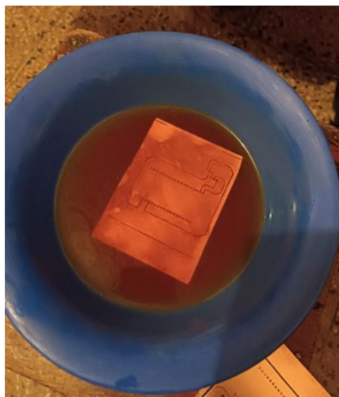
Figura 3.13 Recipiente con la placa sumergida en el cloruro férrico
