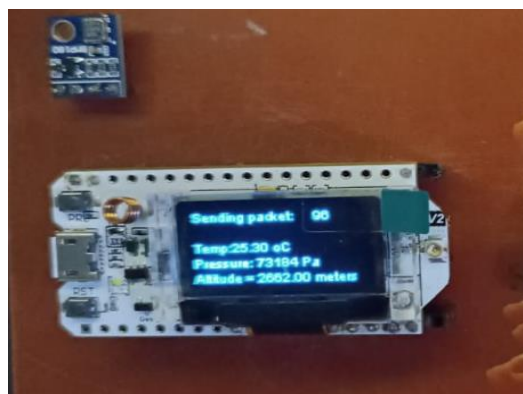
Figura 3.17 Placa terminada con los elementos electrónicos
