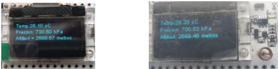
Figura 3.44 Módulo transmisor y receptor con valores de presión y altitud.
