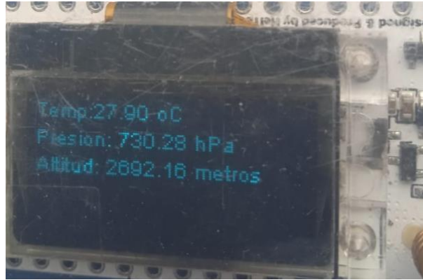
Figura 3.46 Módulo receptor con los valores de presión y altitud.
