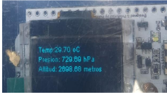
Figura 3.52 Módulo receptor con los valores de presión y altitud.
