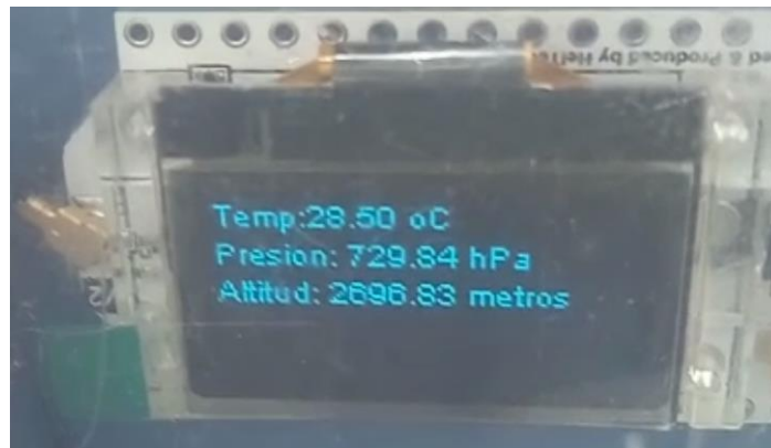
Figura 3.48 Módulo receptor con los valores de presión y altitud.
