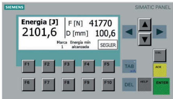
Figura 15: Pantalla del HMI al finalizar un ensayo.
