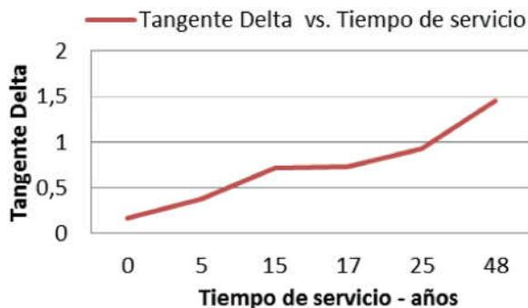
Fig.8. Curva Tangente delta vs. Tiempo de servicio [9].
