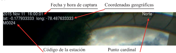
Fig. 8. Visualización de la fecha y hora, coordenadas geográficas, código de la estación y puntos cardinales superpuestos en la fotografía
