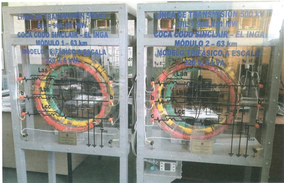
Figura 3 Modelo físico a escala de la línea de transmisión
