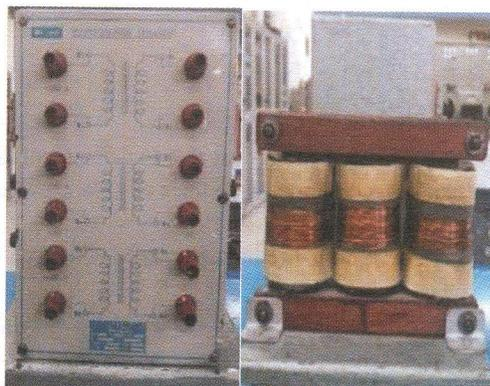
Fig. 7 Transformador trifásico bajo prueba ubicado en el Laboratorio de Máquinas Eléctricas de la EPN
