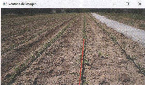
Fig. 15. Marca de navegación identificada
