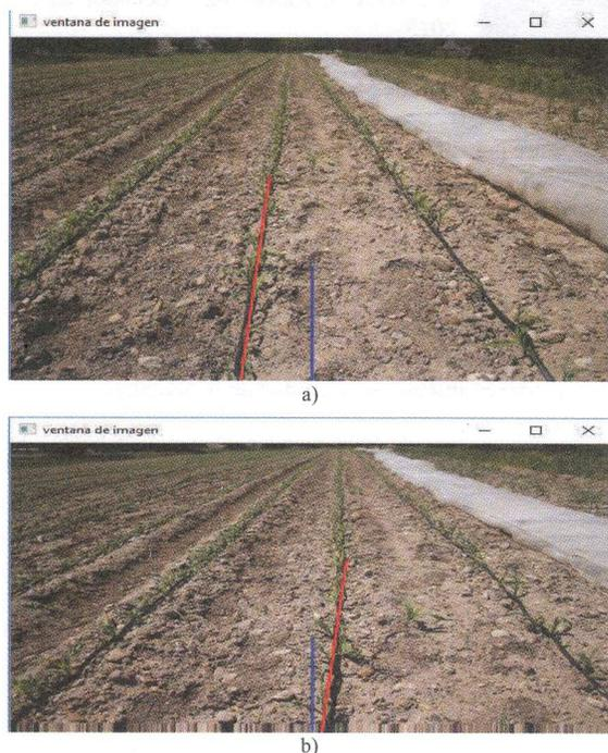
Fig. 18. a) Resultado cultivo 1 ( $d = 15.2\text{cm}$ ,  $\theta = 1.22^\circ$ ). b) Resultado cultivo 2 ( $d = -1.48$ ,  $\theta = 5.49^\circ$ ).
