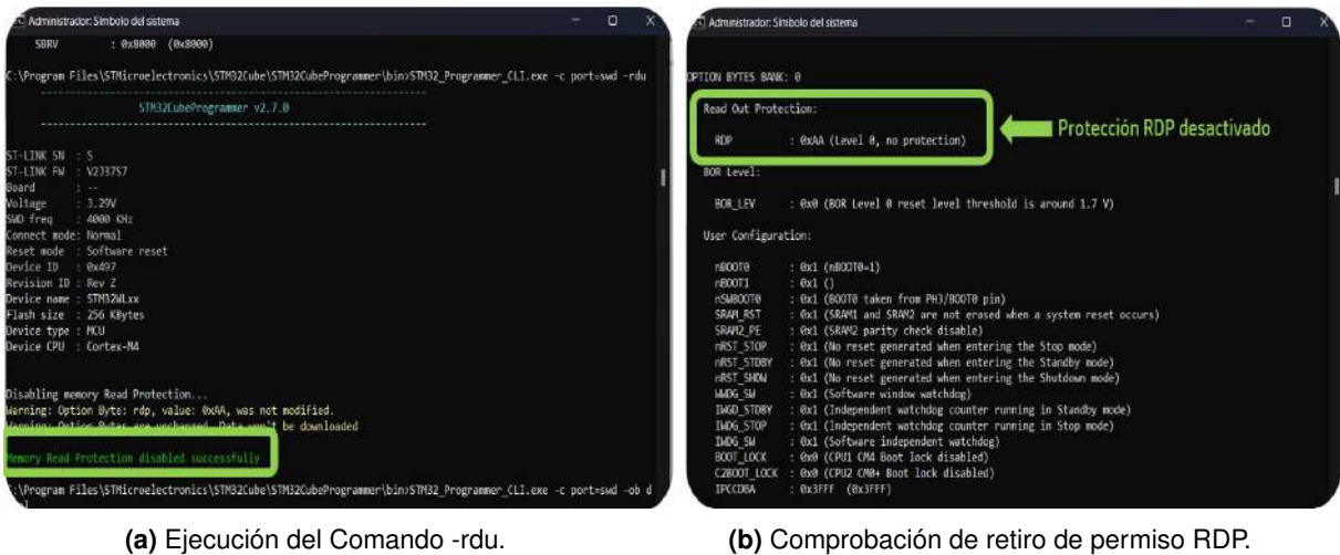
Figura 2.13: Retiro de permisos RDP mediante STM32cubeprogrammer.
