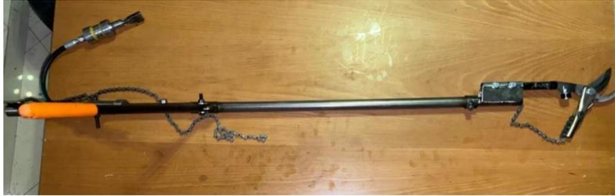
**Figura 35.** Palanca de accionamiento unido al módulo de extensión
