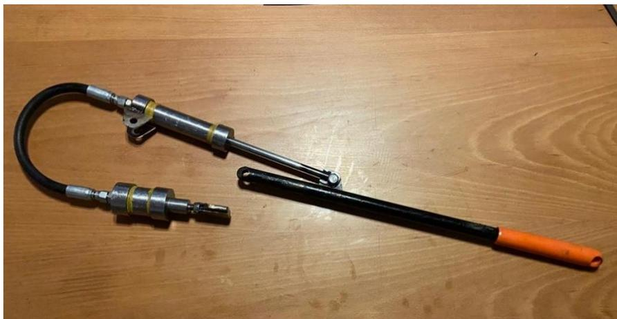
**Figura 34.** Circuito hidráulico unido a palanca de accionamiento
