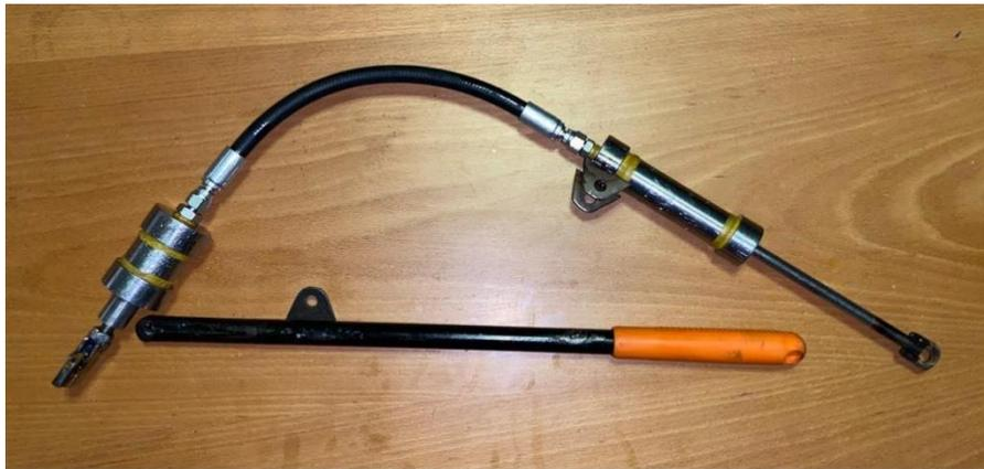
**Figura 33.** Circuito hidráulico unido
