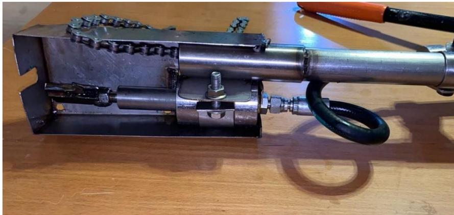
**Figura 36.** Unión del cilindro actuador a la caja de transmisión y base de la pértiga
