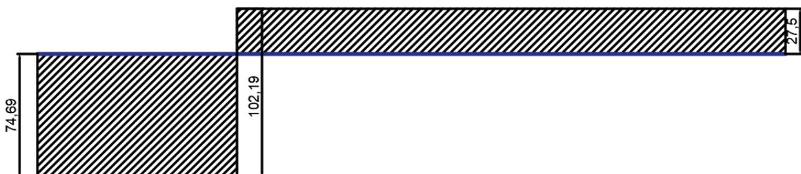
**Figura 24.** Diagrama de cortante [N] de la palanca.
