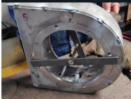
Figura 52. Unión del cuerpo por puntos
