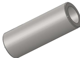
Figura 24. Modelado de cilindro de bisagra
