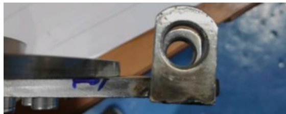
Figura 64. Parte superior de bisagra construida
