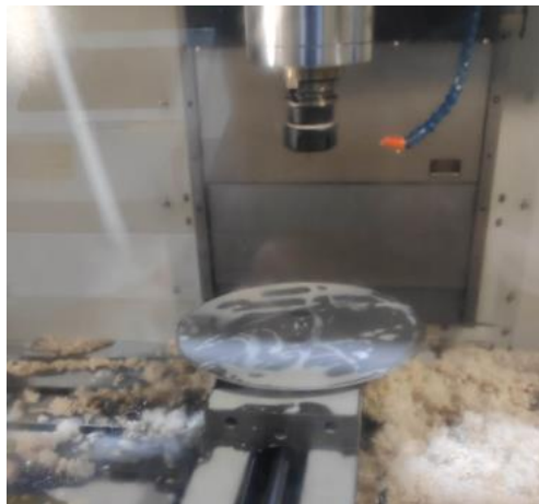
Figura 51. Mecanizado en CNC del tope de tamiz
