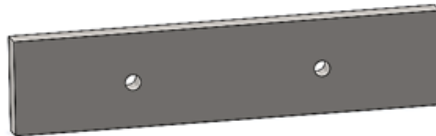
Figura 37. Base inferior de guía de compuerta.
