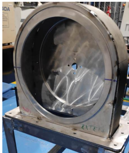
Figura 53. Cámara del molino soldado con puntos
