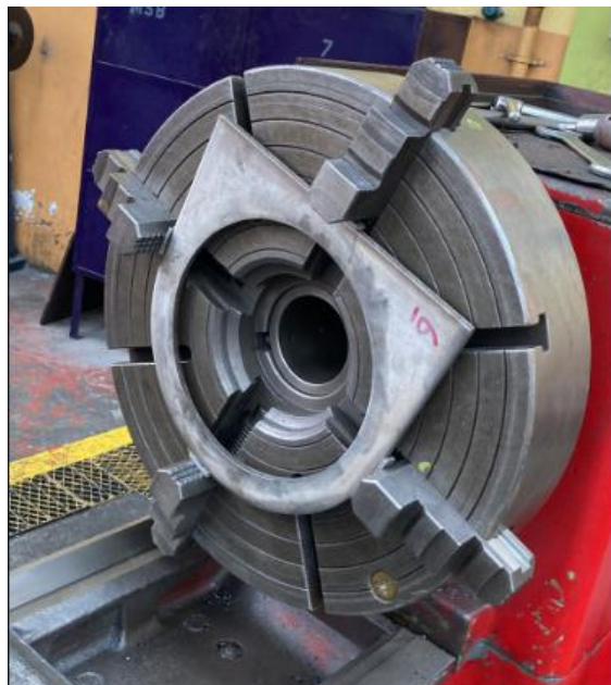
Figura 47. Cilindrado interno de tapa delantera
