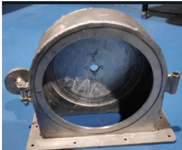
Figura 55. Cámara del molino aplicada el ácido decapante.
