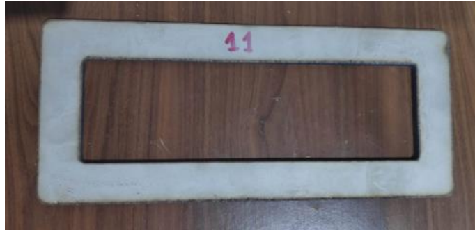
Figura 41. base de Cámara cortada por plasma.
