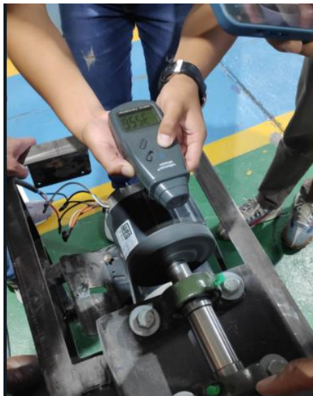
Figura 58. Verificación de RPM con tacómetro.
