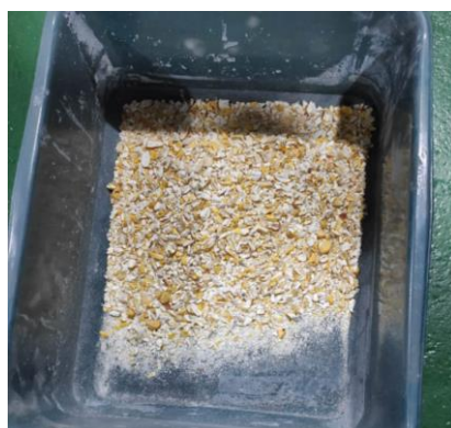
Figura 61. Resultado de molienda sin tamiz
