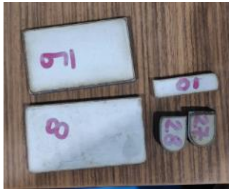
Figura 30. Piezas cortadas por plasma.
