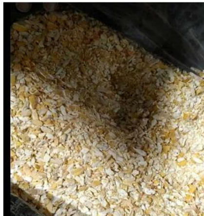
Figura 66. Resultado de la prueba 2 de molienda sin tamiz
