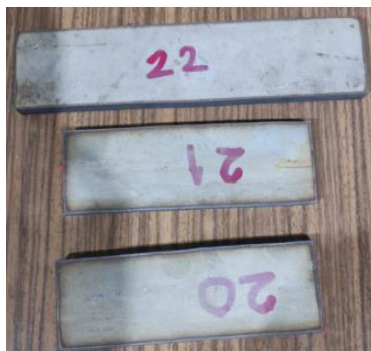
Figura 38. Piezas cortadas en plasma de guías.
