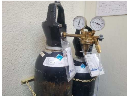
Figura 2.5. Tanques de argón (Fuente: propia).
