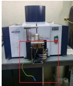
Figura 2.6. Conexiones para purgar el equipo (Fuente: propia).
