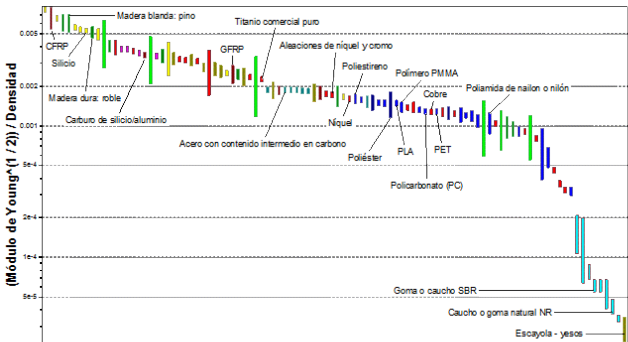
Figura 2.17. Gráfico del universo de materiales comparados con el índice de desempeño de material M para la selección de material para remos. (Fuente: Elaboración propia mediante CES Edupack 2019)
