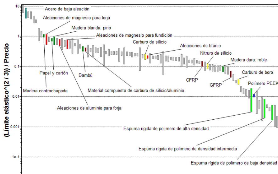
Figura 3.1. Gráfico de materiales comparados con \frac{\sigma_f^{2/3}}{C_m} para la selección de material para horquillas de bicicletas de carreras. (Fuente: Elaboración propia con CES Edupack 2019)
