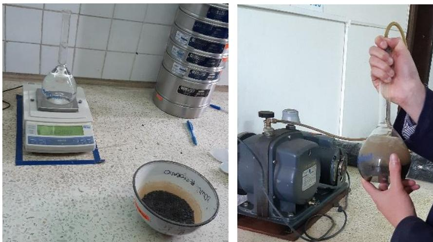
**Figura 13.** Proceso para la obtención de la densidad relativa en agregado fino
