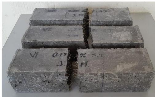
**Figura 37.** Vigas con fibra ensayadas a flexión
