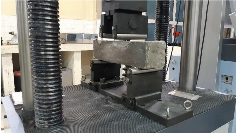
**Figura 27.** Equipo para flexión de vigas
