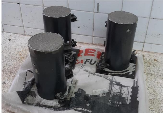
**Figura 23.** Probetas cilíndricas
