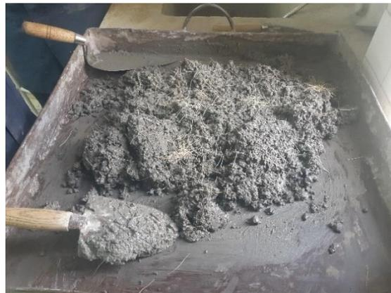
**Figura 21.** Mezcla de hormigón con fibras
