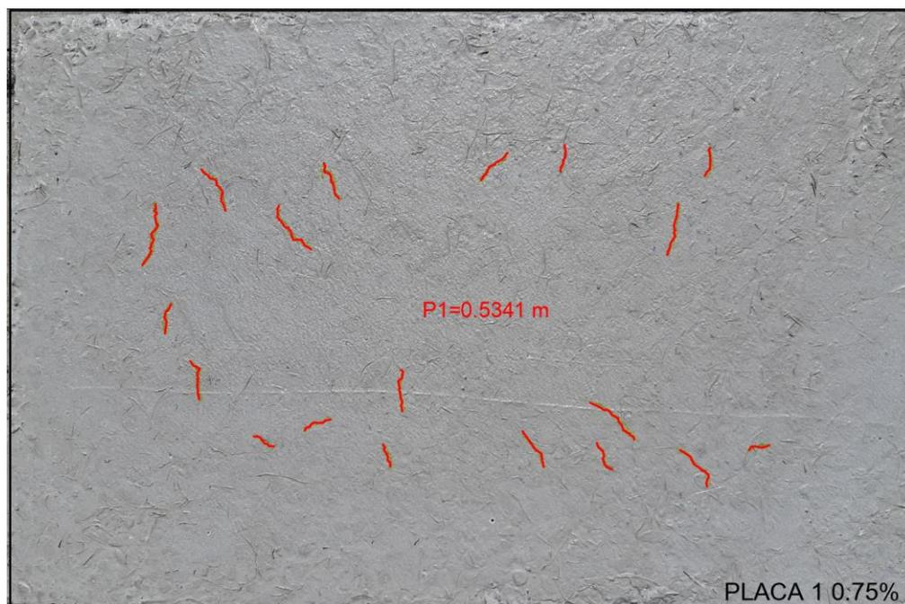
**Figura 30.** Fisuración generada en la placa
