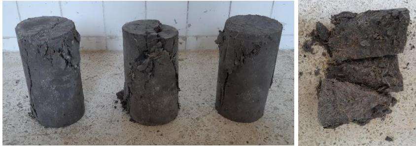
**Figura 36.** Cilindros de hormigón con fibra posterior al ensayo
