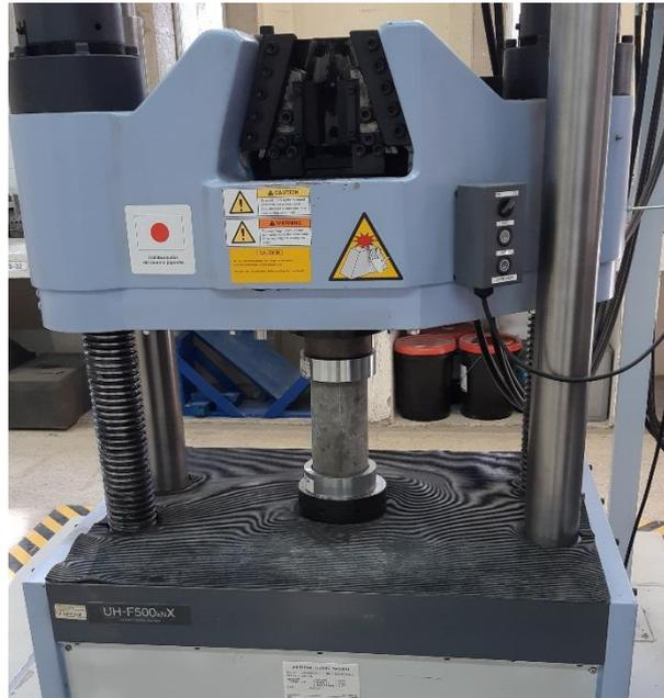
**Figura 26.** Equipo para compresión de cilindros
