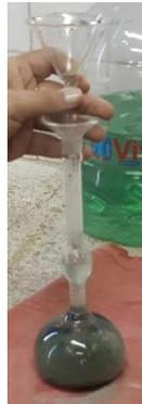
**Figura 8.** Frasco de Le Chatelier con muestra de cemento
