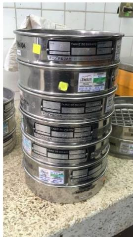
**Figura 12.** Secuencia de tamices para ensayo
