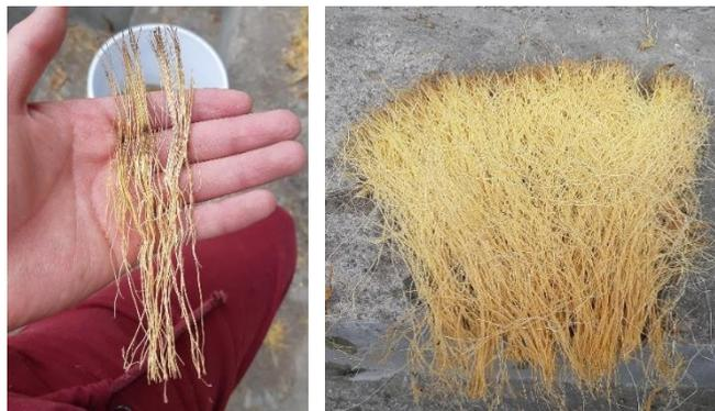
**Figura 17.** Extracción manual de las fibras
