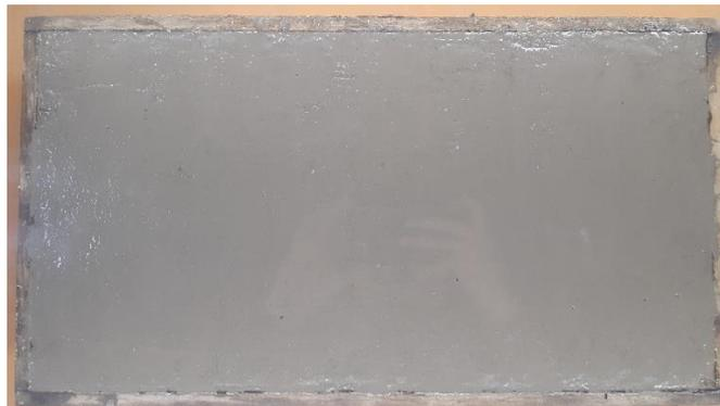
**Figura 22.** Placa de hormigón en molde de madera
