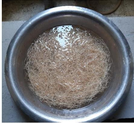
**Figura 20.** Fibra sumergida en agua
