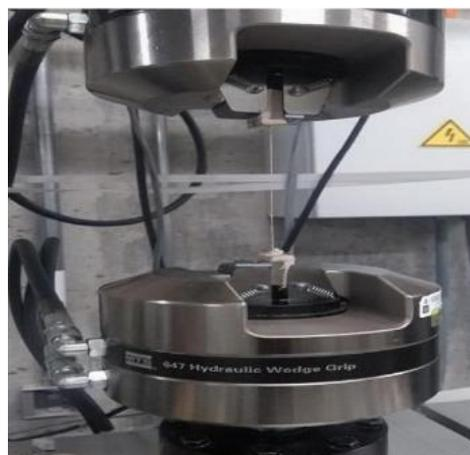
**Figura 6.** Máquina de ensayo universal, MTS BIONIX, con muestra de prueba.
