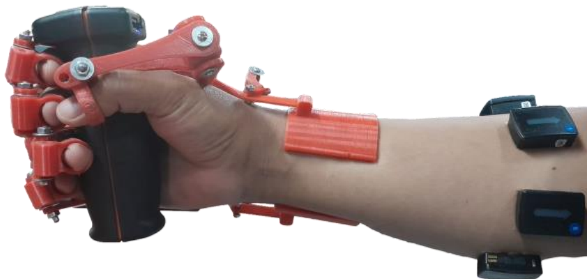
Figura 33. Posicionamiento del sensor Kiev para calibración con exo-esqueleto. [Fuente propia]
