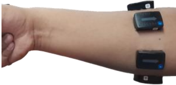
Figura 31. Zona de colocación de los sensores [Fuente Propia]
