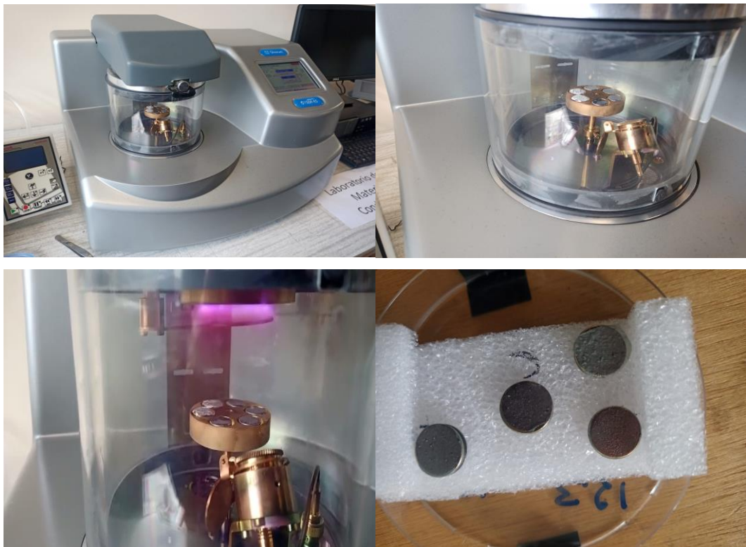
Figura 3.9. Recubrimiento PVD de las muestras para análisis en microscopía SEM.
