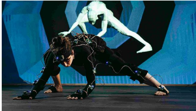
Figura 1.10. Captura de movimiento de un sistema electromagnético (Fuente:[12])
