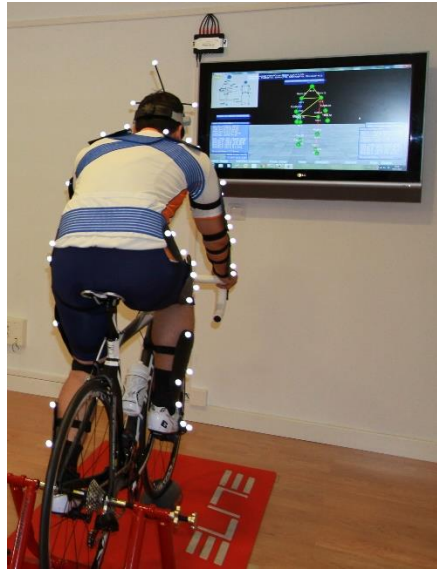
Figura 1.8. Captura de movimientos en tiempo real de un sistema inercial (Fuente:[10])
