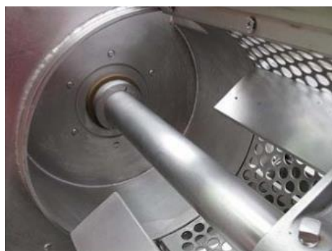
Figura 1.3. Despulpadora semi-industrial de tornillo sin fin. [14]
