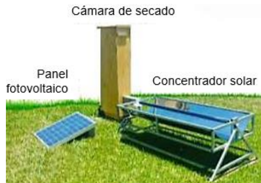
Figura 1.7. Secador solar activo con panel PV y concentrador solar
