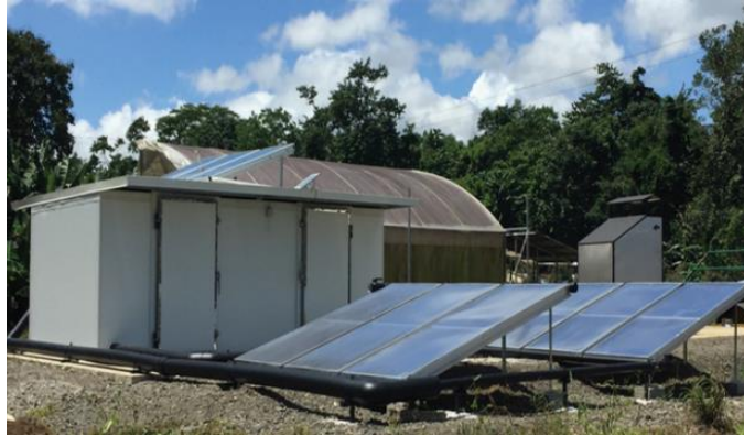
Figura 1.8. Secador solar activo con paneles PVT
