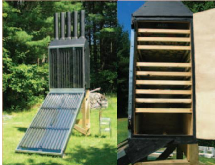
Figura 4. Deshidratación solar indirecta (De Michelis & Ohaco, 2015).
