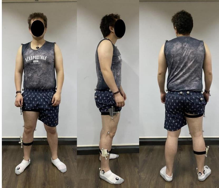
Figura 2.7. Disposición de los marcadores para el análisis en fotogrametría. [Fuente propia]
