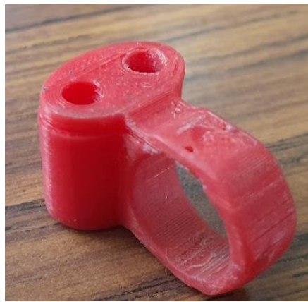
Figura 2. 21. Separación entre capas.
