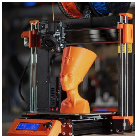
Figura 1. 7. Prusa MK3S+. Dimensiones de impresión 500*550*400 mm. Pero estimado: 7 kilogramos. Temperatura máxima cabezal: 300°C. Temperatura máxima de cama: 120°C.
