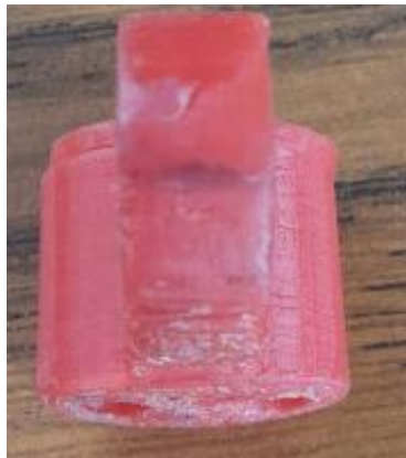
Figura 2. 19. Quemaduras por temperatura excesiva.
