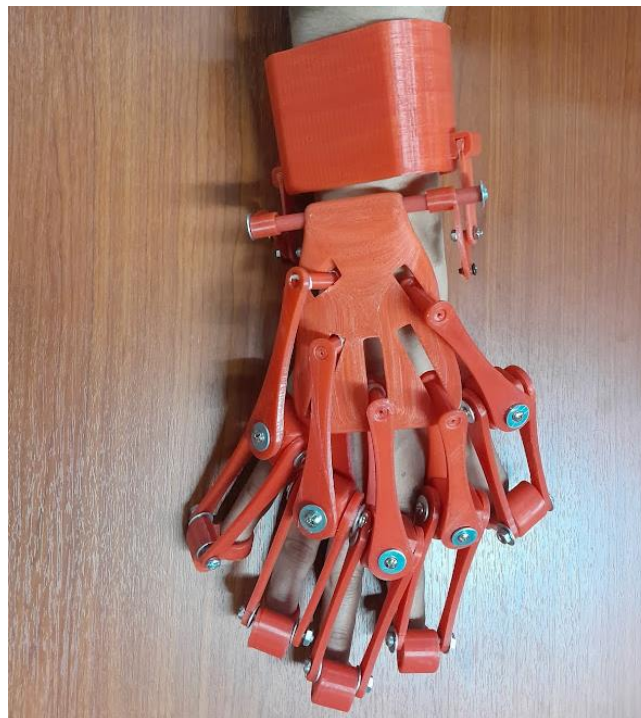
Figura 2. 26. Ensamble completo del exoesqueleto colocado en la mano derecha.
