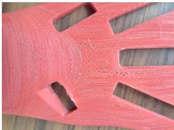
Figura 2. 22. Separaciones y mal acabado en la capa superior
