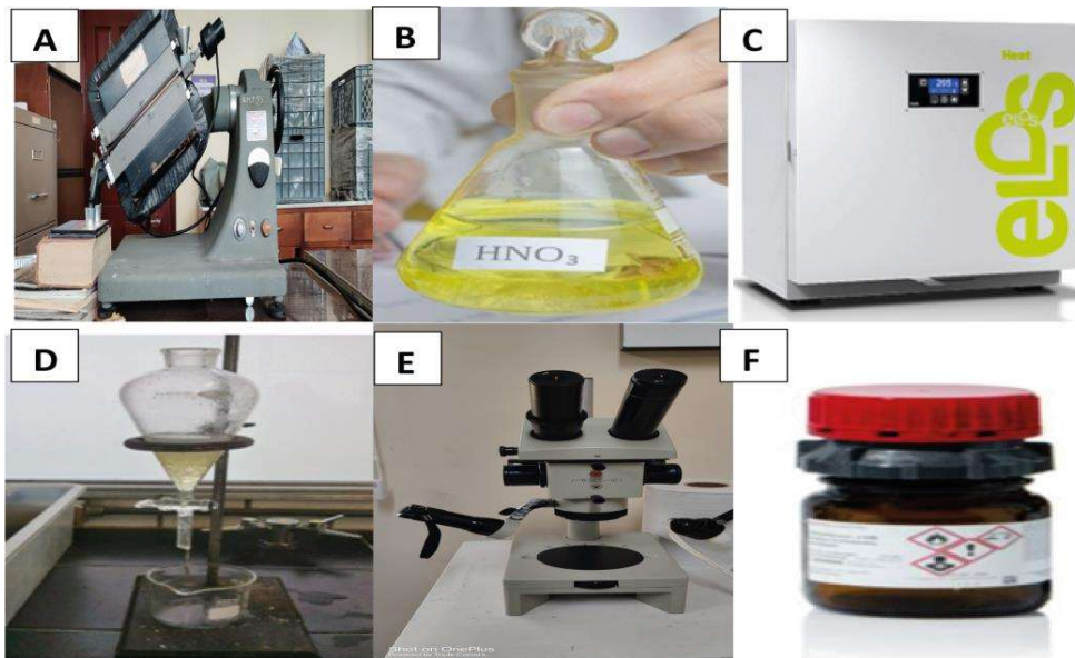
Figura 12. Secuencia alfabética a seguir para desarrollar la metodología (tercera etapa). A. Máquina de separación Frantz B. Ácido nítrico C. Horno D. Separación de minerales mediante líquidos pesados usando peras de separación E. Análisis modal en el binocular F. Polvo de piperina para la elaboración de la lámina delgada.
