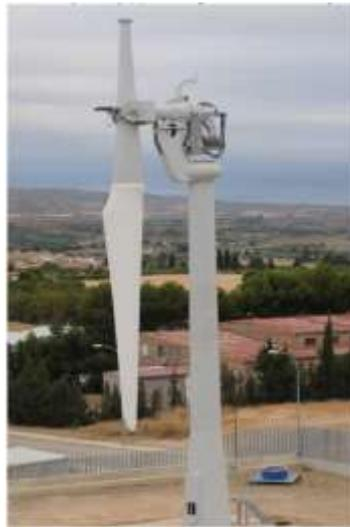
Figura 19. Aerogenerador monopala [15].
