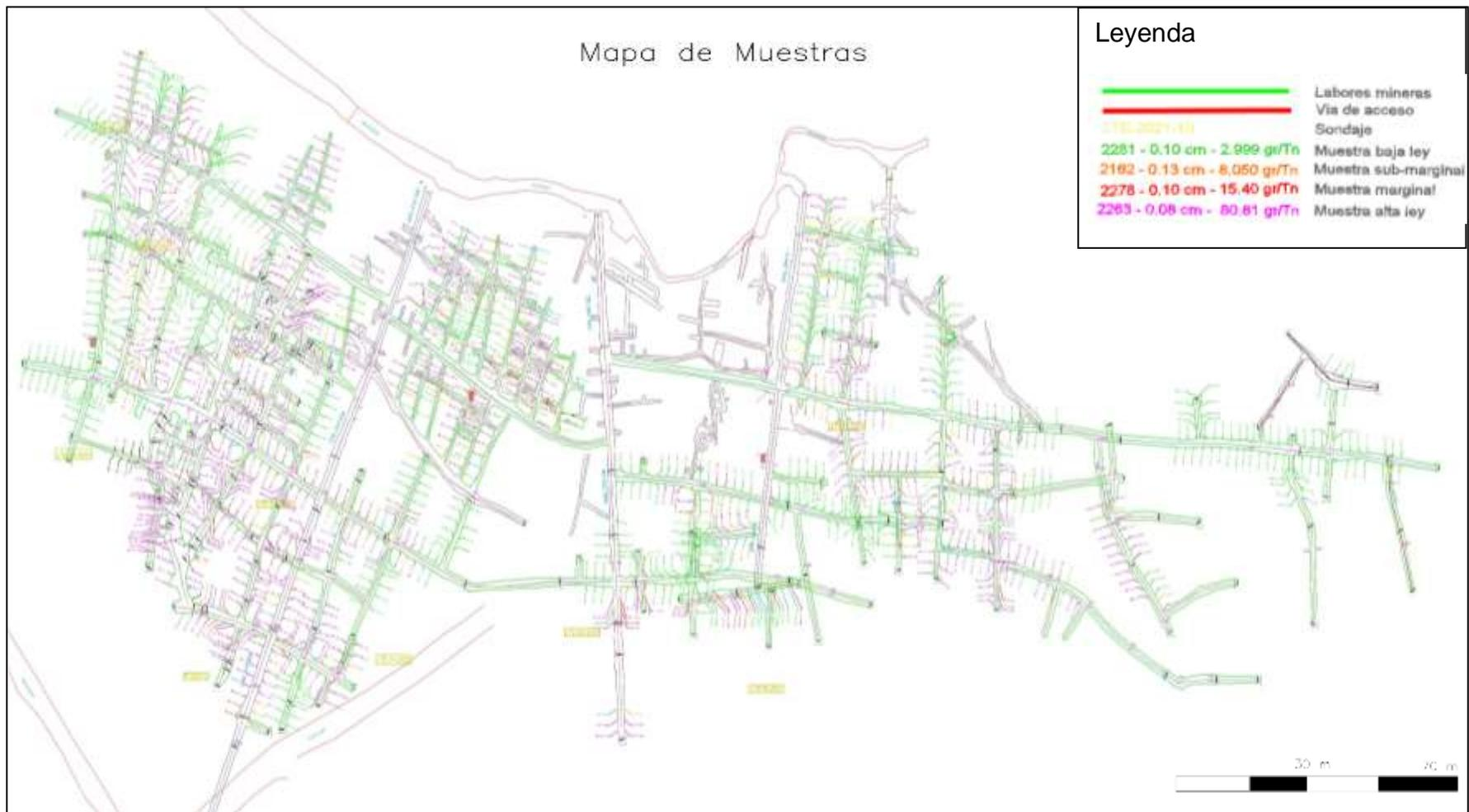
*Figura 4.4* Vista en planta de la ubicación de muestras utilizadas para este trabajo (2700 muestras).
