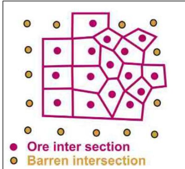
**Figura 1.4:** Método de cuadrados y rectángulos para la estimación de recursos minerales (Haldar, S. K., 2018).
