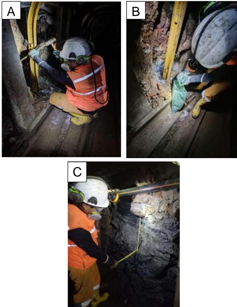
**Figura 3.3:** A) Toma de muestra, B) Codificación y almacenamiento de la muestra y C) Medición de la veta.
