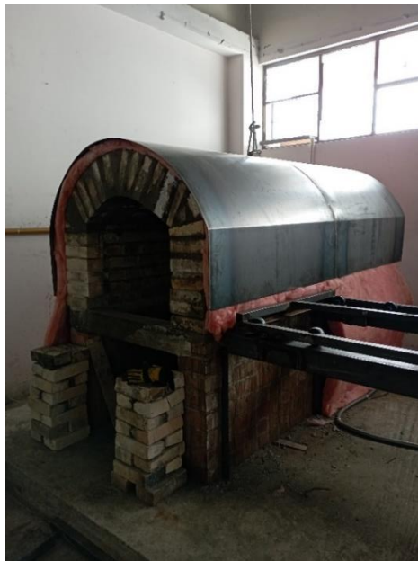
Figura 17. Plancha metálica sobre aislante [Fuente: Propia].
