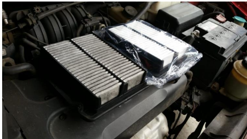
Figura 78.Falla 1 Obstrucción del filtro de aire.
