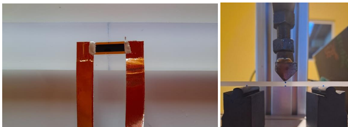
Figura 13. Adherencia de sensor a la probeta y montaje en el equipo. (Fuente: propia)
