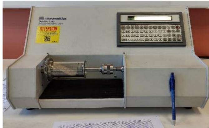
**Figura. 3.9.** Analizador de densidad GeoPyc™ 1360 del Laboratorio de Magmas y Volcanes, Francia. En la imagen se observa la cámara cilíndrica de vidrio con el fluido seco. En la parte superior derecha del equipo se encuentra la pantalla de configuración de los parámetros para las mediciones.
