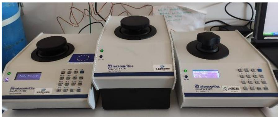
**Figura. 3.10.** Picnómetro de Helio AccuPyc™ II 1340 del Laboratorio de Magmas y Volcanes, Clermont – Ferrand, Francia.
