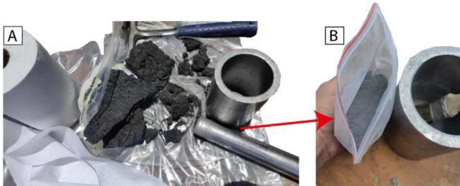
**Figura. 3.12. (A)** Trituración manual de las muestras de roca con la ayuda del mortero de titanio. **(B)**Polvo de roca obtenido después de la trituración con el molino de ágata.
