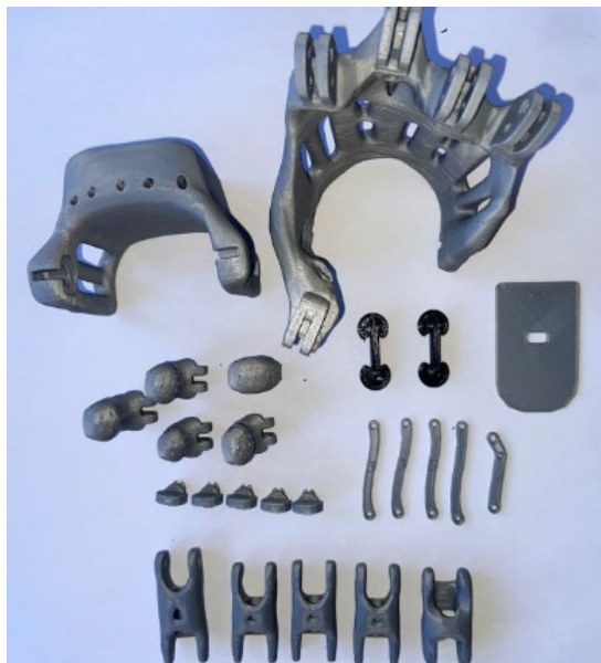
Figura 1.2. Elementos Impresos en PLA
