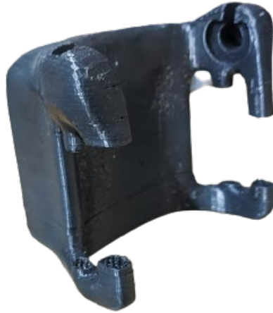
Figura 3.7. Falla del Elemento B a 49,6 lb Impreso en PLA Fibra de Carbono con un 20% de relleno
