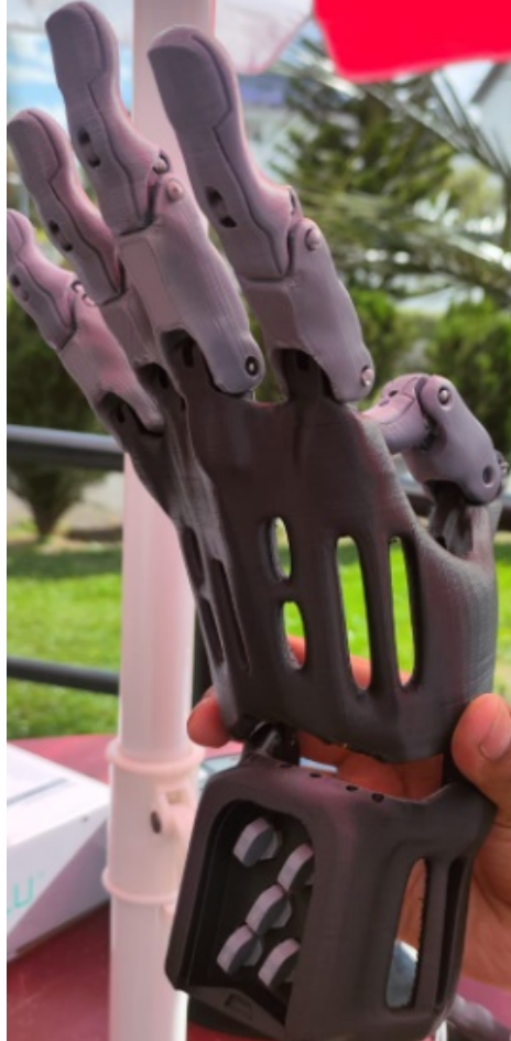
Figura 3.9. Prótesis mixta de dos materiales Ensamblada
