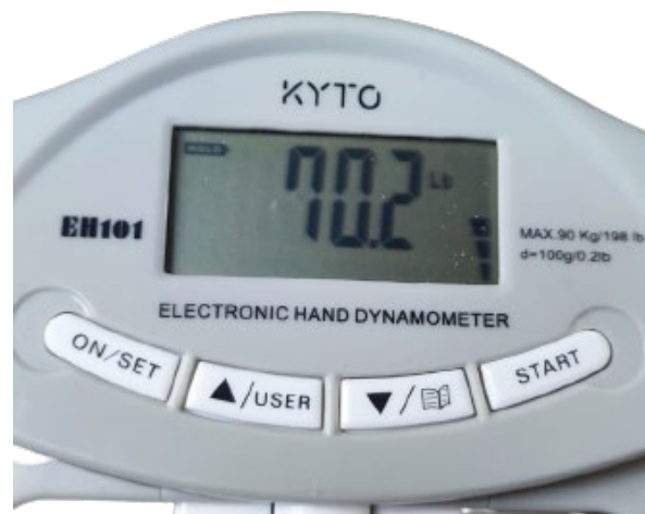
Figura 3.6. Resistencia máxima del elemento A impreso en PLA Fibra de Carbono con un 40% de relleno
