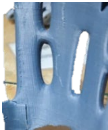
Figura 3.8. Falla del Elemento A de 44,8 lb Impreso en PLA con un 20% de relleno
