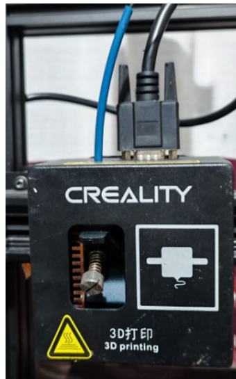
Figura 2.12. Recarga de filamento en el mecanismo de extrusión Directa
