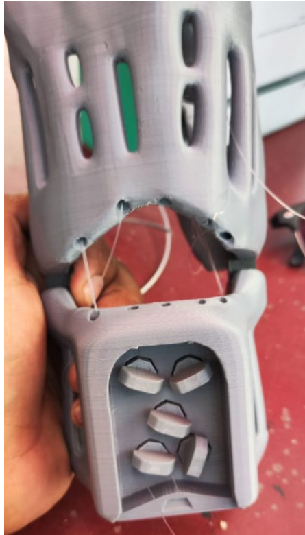
Figura 1.6. Sujeción a los elementos tensores de la Prótesis
