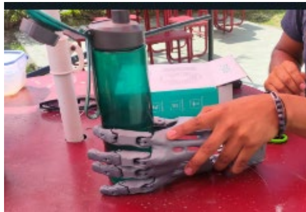
Figura 1.7. Prótesis de PLA Funcional
