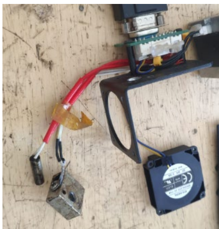
Figura 2.10. Desmontaje del bloque calefactor y ventilador de 24V
