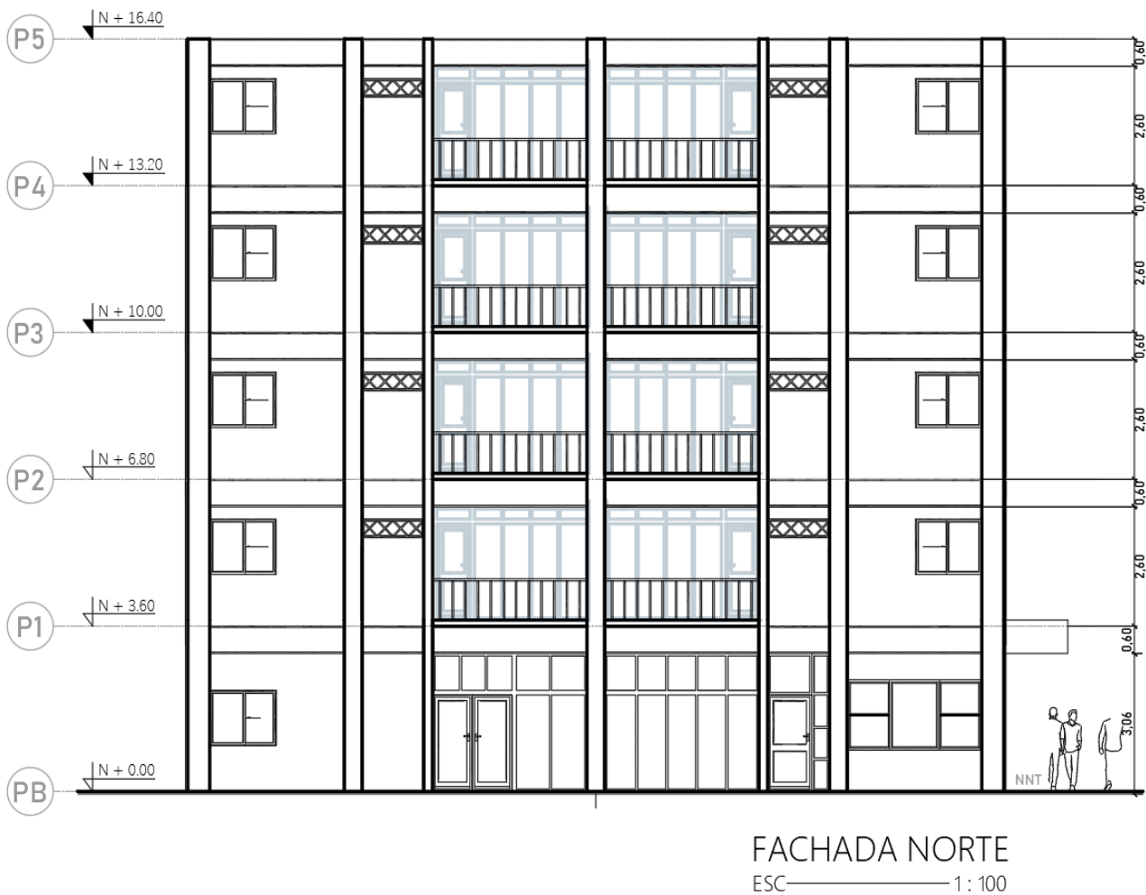
Fig 5. Vista en elevación de la fachada norte
