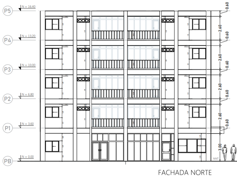
Figura 7. Fachada Norte del edificio de 5 pisos.
